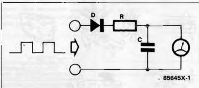
Dans le montage ci-dessus, la source de tension est un générateur de signaux rectangulaires. Chaque impulsion charge le condensateur, à travers une résistance et une diode. La résistance limite l'intensité du courant de charge, la diode interdit la décharge, c'est elle qui *déconnecte* le condensateur de la source après chaque impulsion.
