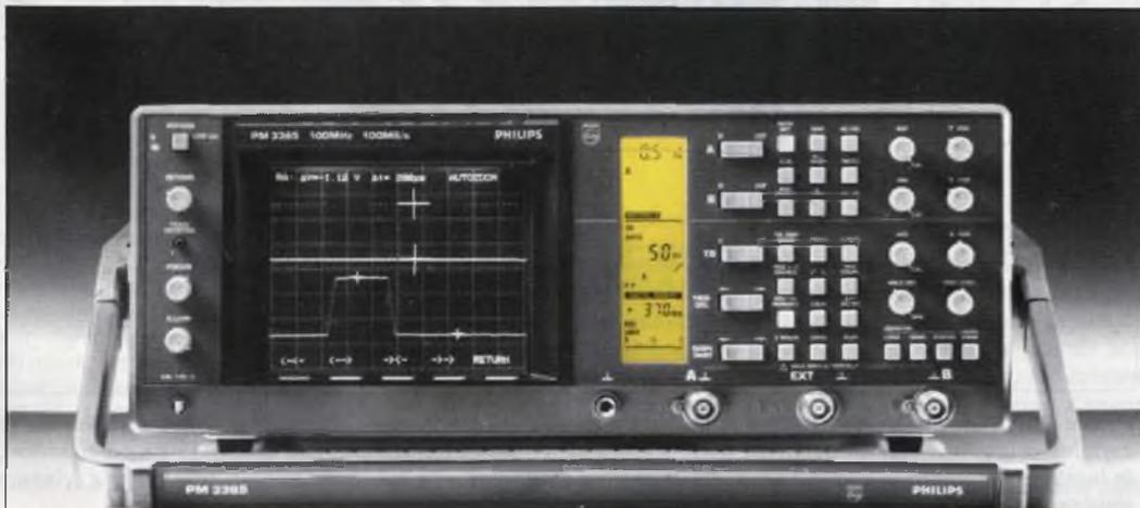
La juxtaposition sur un oscilloscope d'un affichage analogique (sous forme d'un tube cathodique à double trace) et d'un afficheur numérique à cristaux liquides éclairés relève encore du luxe, mais elle confère à cet appareil un confort d'utilisation dont il faut espérer qu'il se banalisera rapidement. Tous les paramètres de réglage peuvent être saisis en un clin d'œil, sans effort et sans risque de parallaxe, sur l'afficheur à cristaux liquides.
