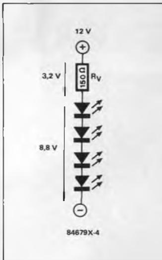
**Figure 4 - Les LED sont des composants qu'il est judicieux de monter en série, non seulement pour récupérer l'énergie dissipée autrement par la résistance de limitation, mais aussi pour accroître l'intensité du rayonnement lumineux. Dans ces conditions la valeur de la résistance de limitation doit être adaptée au nombre de LED. Il n'est pas possible de monter des LED en parallèle.**
