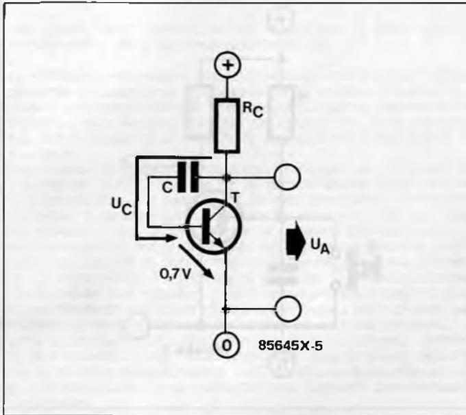
La tension de sortie est égale à la somme de la tension de seuil base-émetteur et de la tension du condensateur.
