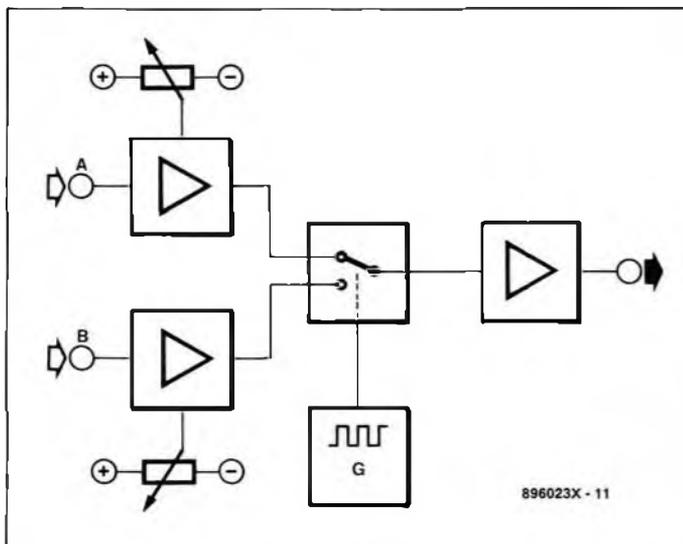
**Figure 2 - Comme il n'est pas capable de tracer les deux courbes à la fois, le faisceau passe rapidement de l'une à l'autre; pendant qu'il représente un segment de l'une, il saute un segment de l'autre. Si le hachage est assez rapide, on ne voit pas le découpage des courbes.**
