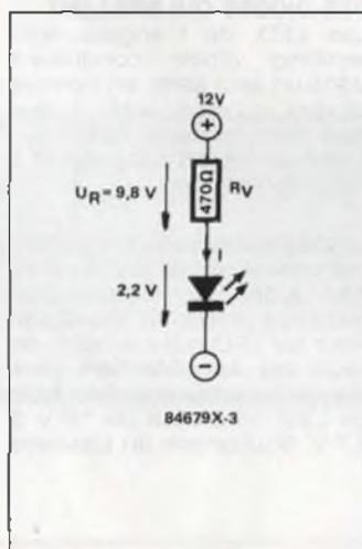
Figure 3 - Une résistance montée en série avec une LED permet de réduire la tension de service. La valeur de cette résistance est déterminée en fonction de la tension de service, compte tenu du courant d'une vingtaine de milliampères et de la tension de service de la LED, de 1,6 V à 2,7 V (selon le type).
