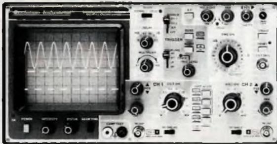
Ligne à retard comprise. Equipée d'un déclenchement du signal et son maintien, le déclenchement coup à coup, le retard de balayage et un testeur de composants, le **CIRCUITMATE 9020** vous apporte l'efficacité d'un appareil très soigné et d'emploi très simple. Garanti 1 an.
