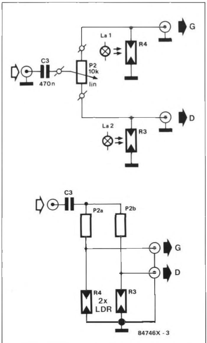
Figure 3 - Le signal ne traverse pas les LDR. Celles-ci sont montées en atténuateur variable avec les deux moitiés de la piste d'un potentiomètre dont le curseur permet de régler la symétrie entre les voies gauche et droite.
