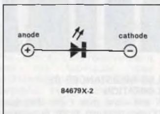
Figure 2 - Comme toutes les diodes, la LED a une anode reliée normalement au pôle positif et une cathode reliée au pôle négatif. Les deux flèches indiquent que ce composant émet de la lumière. Les LED sont de piètres redresseurs en raison de leur comportement médiocre en polarisation inverse.
