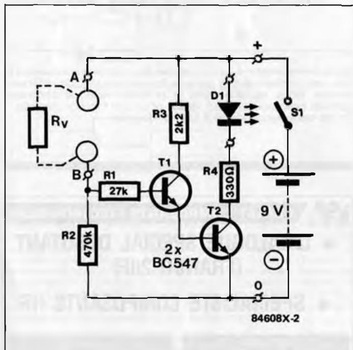
**Figure 1 - Ne cherchez pas la position de la résistance  $R_v$  sur le plan d'implantation. Elle est constituée par la résistance du filament à tester en série avec celle de votre corps. Le montage des transistors ne constitue pas un véritable darlington car les collecteurs ne sont pas reliés ensemble; le gain en courant de l'ensemble est cependant considérable.**
