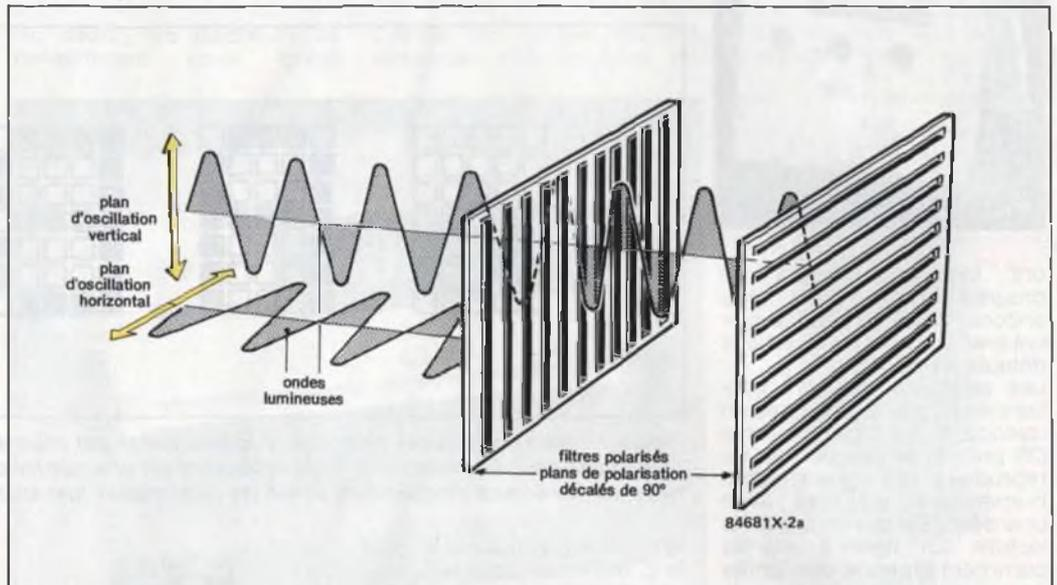
Figure 2a - Toute vibration s'inscrit sur un plan horizontal ou vertical. On dit d'un phénomène ondulatoire qu'il est caractérisé par un plan d'oscillation. C'est le cas aussi de la lumière. Quand deux filtres de polarité opposée sont placés l'un derrière l'autre, la lumière qui traverse l'un est forcément bloquée par le second.
