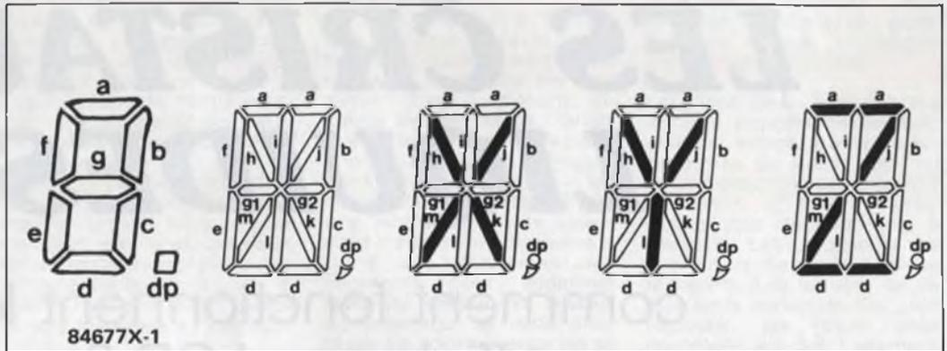
Figure 3 - Pour assouplir la représentation de signes à l'aide d'afficheurs à segments, on a fractionné les segments, rajouté une médiane et deux diagonales. Dès lors il devient possible de reproduire sans équivoque toutes les lettres de l'alphabet (majuscule).
