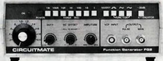
Le générateur de fonctions FG2 avec ses 7 échelles de fréquences (0,02 à 2 MHz) est particulièrement convivial et est destiné à toutes applications concernant les systèmes audio, les ultrasons et circuits utilisant des fréquences inférieures à 2 MHz.
