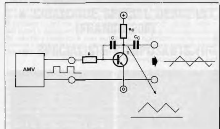
Le condensateur de sortie  $C_S$  **découple** la tension de sortie alternative de la tension continue.
