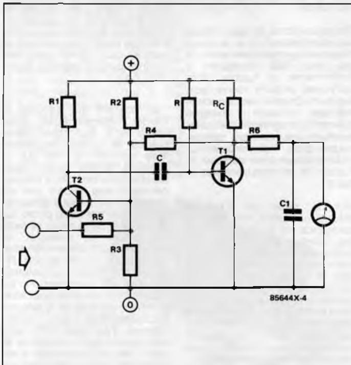
Chaque alternance positive du signal appliqué à l'entrée déclenche une impulsion du monostable et ces impulsions sont "comptées" par le galvanomètre branché en parallèle sur le condensateur du réseau intégrateur R6/C1.
