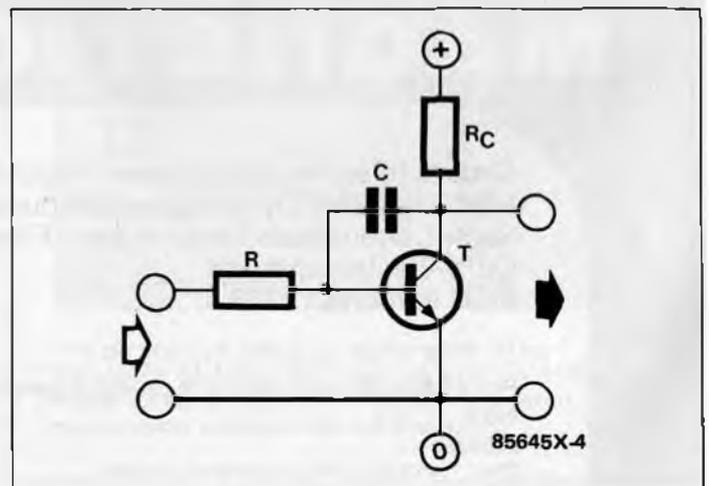
Les caractéristiques de notre circuit intégrateur sont loin d'être optimales. Plus la tension du condensateur augmente et moins le courant de charge est important, puisqu'il dépend de la tension aux bornes de la résistance. Un transistor permet d'améliorer le montage.
