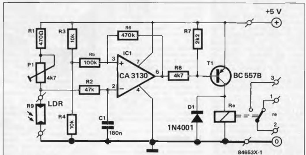
Figure 1 - Le schéma de la barrière lumineuse se présente sous la forme d'un comparateur avec deux diviseurs de tension; l'un est fixe (R3/R4) et l'autre varie en fonction de la lumière qui trappe la LDR (R9/P1/R1).
