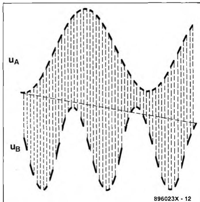
**Figure 3 - Principe de fonctionnement du hacheur. Les deux signaux à visualiser sont appliqués à l'entrée d'un commutateur électronique commandé à une fréquence élevée par un générateur de signaux carrés. Le signal de sortie attaque l'entrée unique de l'oscilloscope sur l'écran duquel apparaît un signal unique composé par la superposition des signaux d'entrée.**
