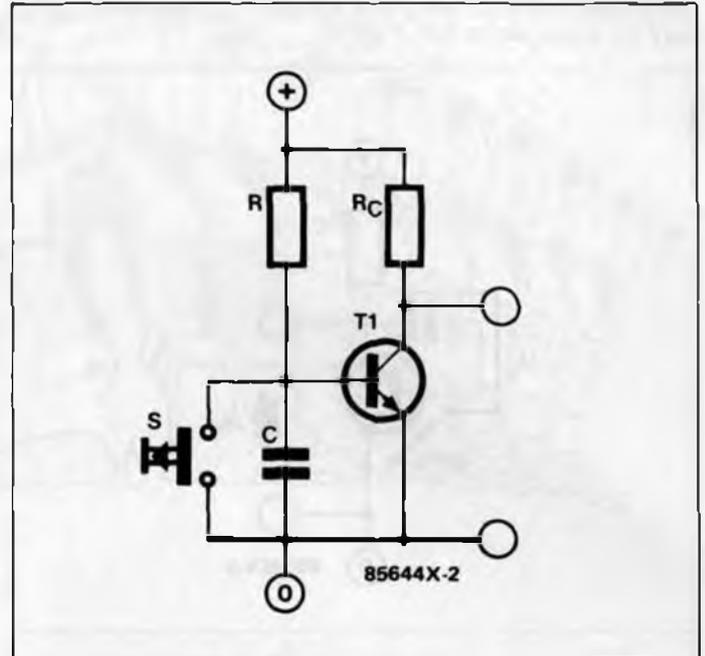
0,7 V, le transistor redevient conducteur et sa tension de collecteur retombe à zéro. Le temps de charge est une fonction de la valeur de R et de C, on l'appelle constante de temps du réseau RC. Le but n'est pas encore atteint car l'impulsion positive de sortie comprend la durée de la pression sur le poussoir. Nous devons nous débarrasser de cette incertitude, d'autant plus qu'il n'est guère possible d'appuyer cinquante fois par seconde sur un poussoir pour mesurer la fréquence du secteur.
