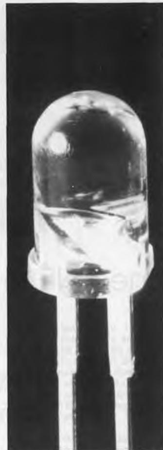
**Figure 6 - Par transparence on reconnaît la cathode à son électrode plus massive que celle de l'anode. La broche de la cathode est plus courte et le boîtier est aplati de ce côté là. Une inversion de polarité («juste pour voir») reste sans conséquences à condition que la tension appliquée ne dépasse pas la tension de service normale.**
