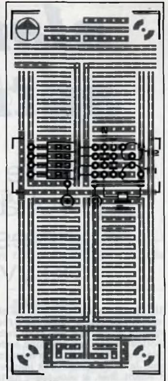
Figure 4 - Le plan d'implantation ne présente pas de difficulté, sinon que la broche de base de T2 doit être croisée pour venir se fixer devant les deux autres.
