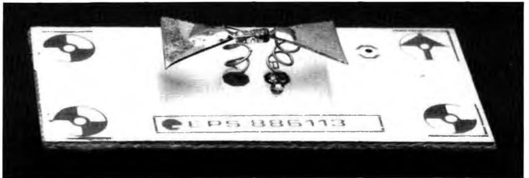
**Figure 3 - Si vous examinez d'un oeil critique cette photographie de l'un de nos prototypes du détecteur, vous découvrirez une erreur à ne pas commettre. La voyez-vous ? C'est la polarité de D1 qui a été inversée ! En tous cas, la liaison entre la pointe des triangles équilatéraux et les broches de la diode doit être aussi courte que possible.**
