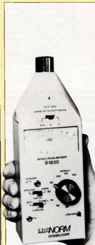
Figure 8 - Un appareil de mesure professionnel utilisé pour la protection contre le bruit. La plage de mesure s'étend de 35 à 130 dB(A). Pour ces derniers niveaux, il existe -heureusement- une sortie pour la lecture à distance.
