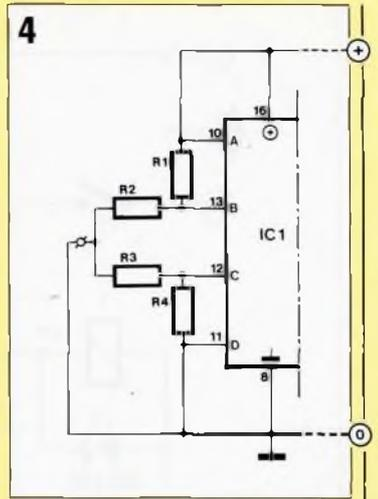
**Figure 4 - Principe du court-circuit de la branche inférieure du diviseur par un niveau logique d'entrée bas. Le même principe s'applique à la moitié supérieure du diviseur quand l'entrée est au niveau haut.**
