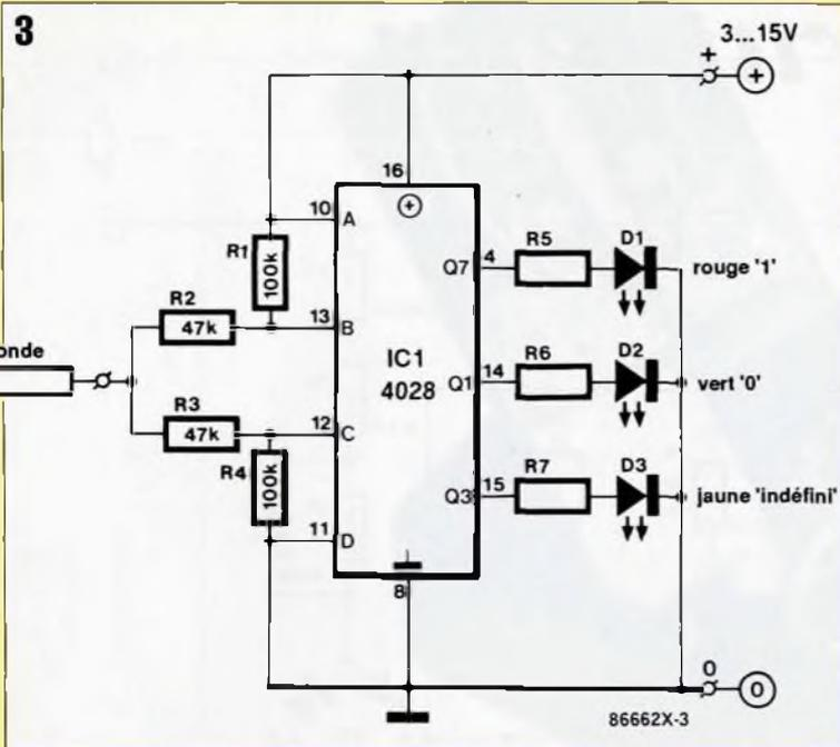
**Figure 3 - Schéma d'un testeur pour circuits logiques CMOS réalisé à l'aide d'un décodeur BCD-décimal. L'information d'entrée n'est pas une valeur numérique décimale codée en binaire (binary coded decimal); c'est en faussant l'équilibre d'un diviseur de tension à l'aide du niveau logique à tester que l'on polarise deux des quatre entrées d'IC1 tantôt au niveau haut, tantôt au niveau bas.**
