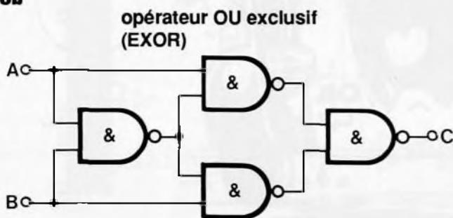
Figure 3b - Il faut 4 opérateurs NON-ET pour réaliser une fonction OU exclusif, ce qui n'est justifié que dans des cas extrêmes, par exemple quand on est dans l'impossibilité de trouver un circuit intégré de type 4077. La symétrie du dispositif à quatre opérateurs NON-ET reflète la symétrie de la table de vérité, détail qui ne manquera pas d'intéresser ceux qui cherchent à comprendre la relation OU exclusif de la sortie C avec les entrées A et B.
