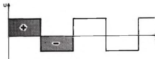
(superposition) d'une tension continue et d'une tension alternative, appelée aussi quelquefois tension continue pulsée. C'est ce que schématise la figure 9 ci-contre.
