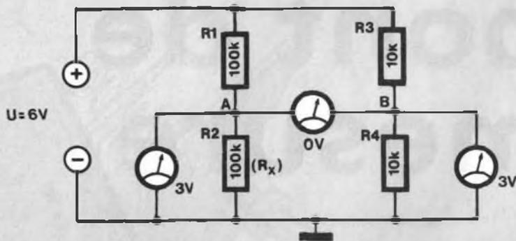
Figure 2 - Nous avons développé le schéma de la figure précédente. Les rapports entre les résistances sont mis en évidence. Les deux diviseurs ( $R1/R2$  et  $R3/R4$ ) produisent aux points A et B une tension de 3 V par rapport à la masse. La différence de tension entre les points A et B est
