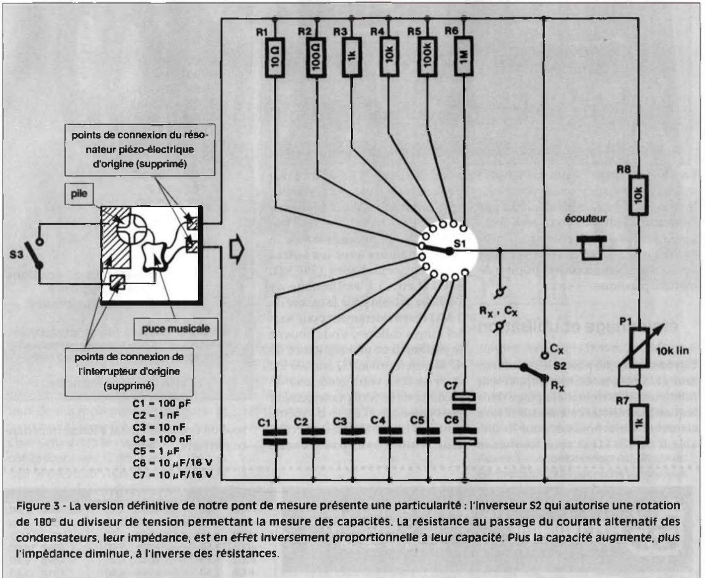
Figure 3 - La version définitive de notre pont de mesure présente une particularité : l'inverseur S2 qui autorise une rotation de 180° du diviseur de tension permettant la mesure des capacités. La résistance au passage du courant alternatif des condensateurs, leur impédance, est en effet inversement proportionnelle à leur capacité. Plus la capacité augmente, plus l'impédance diminue, à l'inverse des résistances.
