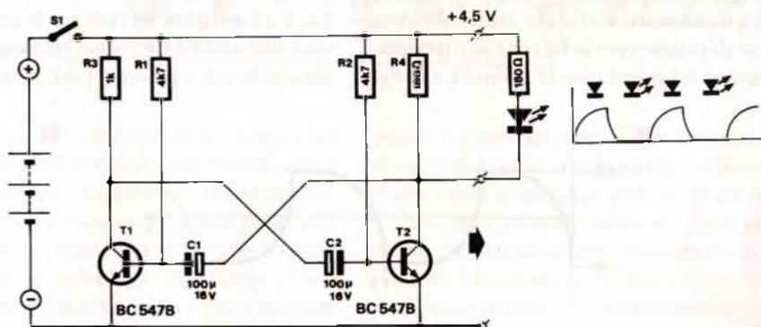
La situation change : avec un condensateur (sur la **figure 4**, un modèle chimique de 1000  $\mu$ F/16 V) placé devant la paire de diodes, celles-ci se mettent à clignoter en alternance, comme les deux ampoules de la figure 3 du premier épisode.
