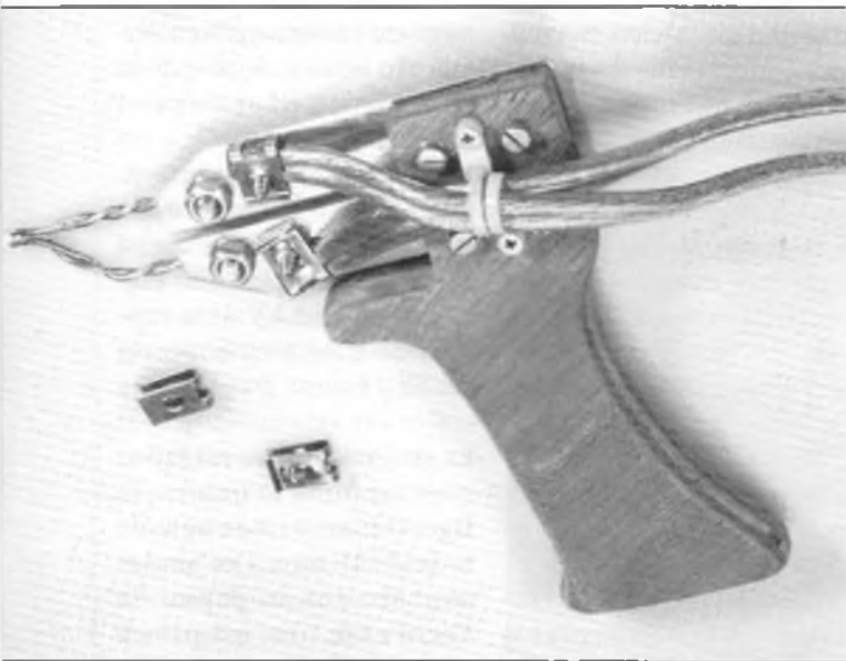
Figure 5 - Détail de la poignée du fer à souder maison. Les surfaces de contact entre la panne, la tôle d'aluminium les câbles est aussi grande que possible et le serrage énergétique, tout cela pour limiter les pertes d'énergie. Les câbles sont serrés dans des cages pour vis à tôle. Si vous utilisez de l'aluminium anodisé, il faudra d'abord éliminer la couche d'alumine (hydroxyde d'aluminium) car elle est isolante. La panne chauffante est façonnée au marteau dans du fil de fer galvanisé.
