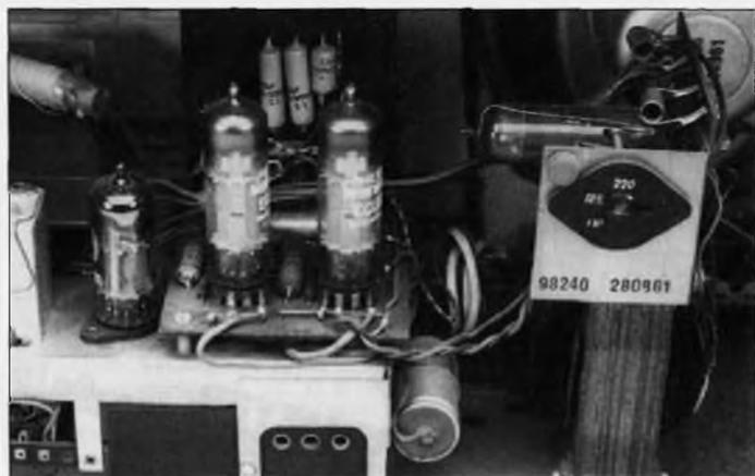
Figure 2 – Des plaquettes à cosses facilitaient une partie du câblage.
