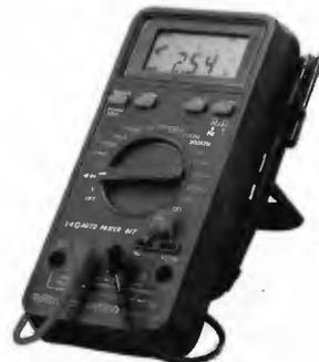
Das DM 280 verfügt über den gesamten Meßkomfort des DM 250 – ist allerdings nicht wassergeschützt. Dafür bietet das Gerät zusätzlich 3 Frequenzmeßbereiche bis 200 KHz und 5 Kapazitätsmeßbereiche bis 20 µF.
