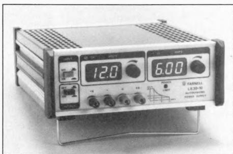
Mit dem Labornetzgerät LS 3010 des englischen Herstellers Farnell hat der Distributor nbn-Elektronik ein leistungsstarkes Labornetzteil in den Vertrieb übernommen. Das 2,1 kg leichte Gerät weist einen Ausgangsspannungsbereich von 0...30 V auf, der maximale Ausgangsstrom beträgt 10 A. Um die bei derart hohen Strömen die in den Leitungen zum Verbraucher entstehenden Spannungsverluste kompensieren zu können, wurden die
