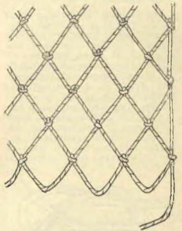
**FIG. 4** — Ecco come appare un tratto della rete a diamante, dopo che è stato sistemato anche lo spago che la delimita nel senso della lunghezza. La cosa da curare è la regolarità delle maglie, che debbono risultare tutte della medesima lunghezza e larghezza. Ottenere questo risultato non è difficile: quanto occorre è usare sempre la stessa tensione nello stringere i nodi, cosa questa alla quale si perviene in poco tempo istintivamente dopo i primi tentativi.
