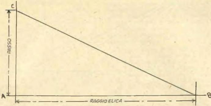
FIG. 26. — Primo stadio nel calcolo del passo di un'elica autoconstruita. A-B è di lunghezza uguale al raggio dell'elica; A-C uguale al passo. Ambedue queste misure possono essere determinate tenendo presente quanto abbiamo detto nel testo
