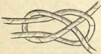
FIG. 5 — Quando occorre ricaricare l'ago, i due capi si uniscono con il nodo del tessitore, o nodo piatto. Si fanno due cappi, quello di sinistra s'introduce dentro quello di destra, i cui capi s'intrecciano come indicato nella illustrazione. Il risultato è un giunto solido, assolutamente sicuro e per di più di pochissimo ingombro.
