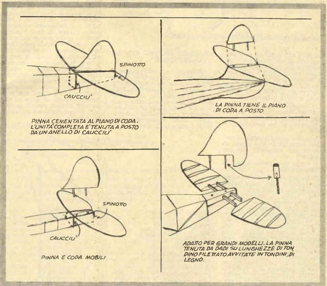
FIG. 19 — Ecco quattro sistemi per fissare i piani di coda alla fusoliera. La scelta da loro dipende esclusivamente dal modello. Per principianti è consigliabile quello illustrato nel particolare in alto a sinistra, indubbiamente il più semplice ed adattissimo a modelli di dimensioni e peso non eccessivi, che prevede il montaggio a mezzo di un anello di caucciù.
