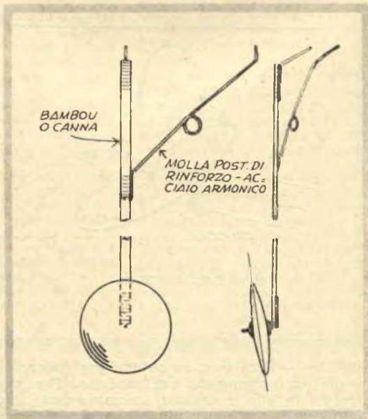
FIG. 21. — Questo tipo è più solido e presenta inoltre il vantaggio di poter agevolmente essere separato dal modello, cosa utilissima, perché permette di trasportare e riporre il modello stesso in una scatola di piccole dimensioni
