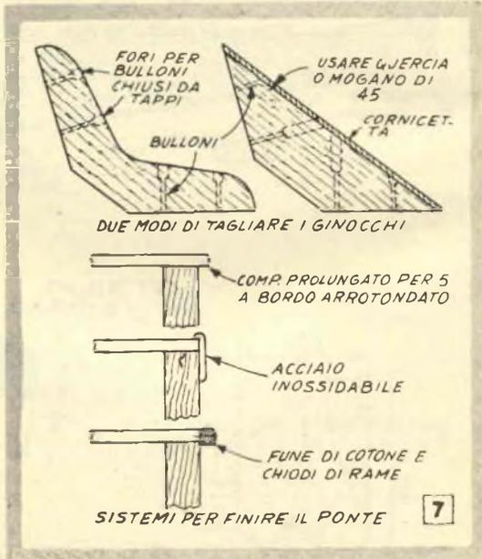
In alto, due sistemi per eseguire i rinforzi dell'asse di poppa. Non ha importanza quale venga usato. Notare il sistema per la messa in opera delle viti, le cui teste vengono profondamente affogate nel legno e poi ricoperte con tasselli di legno. Sotto tre modi per finire con eleganza il bordo del ponte. Particolarmente semplice ed estetico il terzo, che consiste nel nascondere il bordo con una cornicetta formata da una corda fissata con qualche chiodino.
