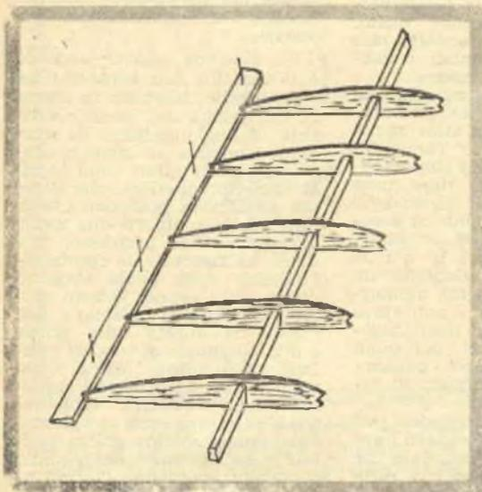
Fig. 15. — Prima fase della costruzione di una semiala. Una volta rifiniti il bordo di uscita ed il longherone, e fatti nelle singole centine gli incassi necessari, i primi due pezzi vengono fissati sul disegno, ed a loro, nei punti indicati, vengono cementate le singole centine
