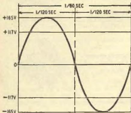
Fig. 1 - Grafico di un ciclo (tensione 165 volts, frequenza 60).
