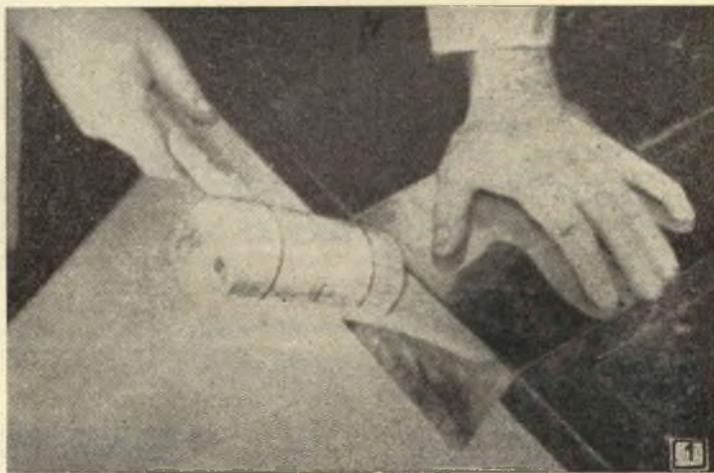
Foto 1 — Come si piega una lamiera di metallo, servendosi del bordo del banco come guida. Il metallo vien colpito proprio al di sotto della linea della piegatura con il mazzuolo.
