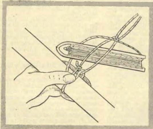
**FIG. 2** — Ecco come il lavoro viene iniziato. L'anello che finisce nell'angolo alto a destra serve per appendere la rete ad un gancio. Il secondo (anello iniziale) per fissarvi le maglie del primo giro. Notate come il pollice stringe il filo: non lo deve lasciare, sino a quando il nodo non è tirato. Osservate anche come il filo è avvolto intorno all'ago, che dev'essere ben carico, ma non eccessivamente rigonfio.
