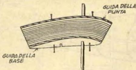
FIG. 11. — Se l'ala è affusolata, occorre fare i modelli della prima e dell'ultima centina di una semiala, ritagliarli in compensato e serrare tra di loro tanti pezzetti di balsa, quante sono le centine necessarie.
