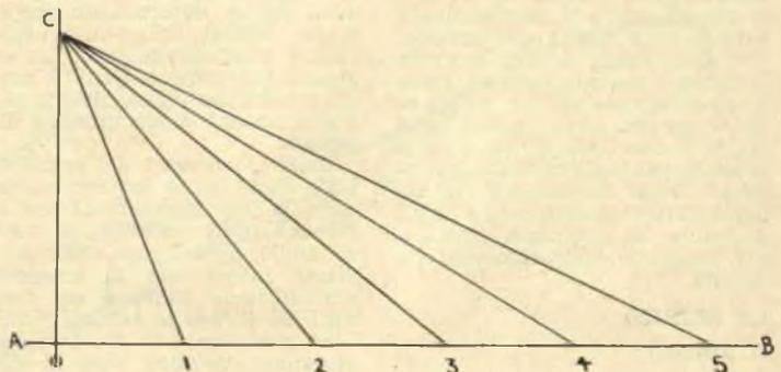
Fig. 27. — Secondo stadio del calcolo. Il segmento A-B viene diviso in 5 parti uguali ed i punti così trovati vengono congiunti a C. Gli angoli formati da questi segmenti con A-B indicano l'angolo che il bordo dell'elica da costruire deve avere nei punti corrispondenti.
