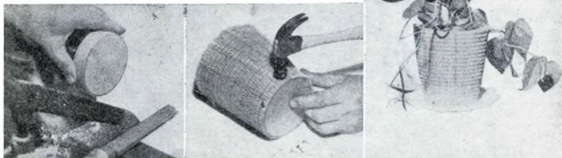
Tornite o segate la base del vaso da un pezzo di pino, facendola di diametro di circa 25 mm. superiore a quello del fondo del vaso. Smussatene lo spessore, in modo da portare quasi a misura la superficie che rimarrà in alto, quindi inchiodate la canna a questa base, usan-
