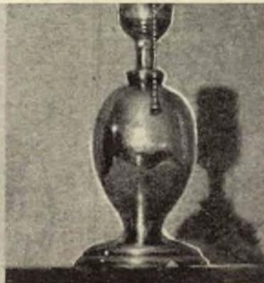
Un recipiente tipico, in cui si fa avvenire la deposizione. Si noti come l'estremità superiore dell'asse è impegnata nella puleggia che comandata dal motorino la costringe ad una lenta rotazione, importante per la regolarità della deposizione su ogni punto del modello di cera. Nel testo viene suggerito un metodo per fare a meno della rotazione.
