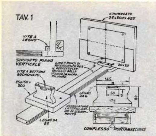
*Dettagli costruttivi della attrezzatura per microfilm nella sua prima versione. Le parti occorrenti possono essere recuperate da un vecchio cavalletto da pittore oppure possono essere costruite ex-novo, senza alcuna difficoltà.*
