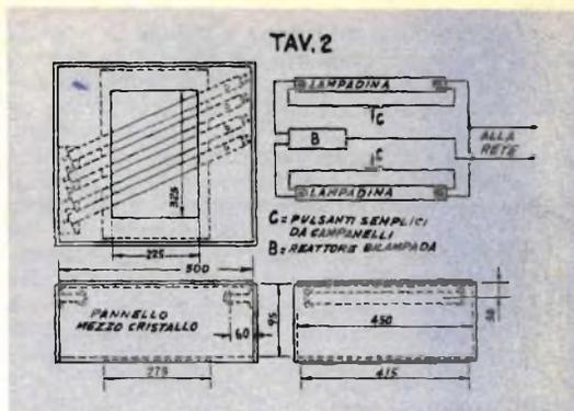
Dettagli costruttivi del complesso per microfilm, nella seconda versione, portatile. Il dettaglio in alto a destra è lo schema elettrico di collegamento delle due lampade fluorescenti di illuminazione al singolo reattore bilampade. I pulsanti sono usati semplicemente al posto degli starter termici ad incandescenza.
