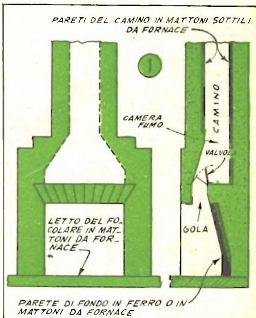
Sezione frontale e sezione laterale di un caminetto tipico, in cui possono osservarsi le parti principali. Se la posizione della colonna ascendente è perfettamente centrata rispetto al cielo del caminetto si crea una delle condizioni ideali per il buon funzionamento.
