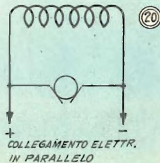
si abbia cura di evitare l'impiego di filo recuperato anche se in buone condizioni e si dia, senz'altro, la preferenza al filo nuovissimo. Nello statore vanno avvolti 19 strati di filo, con 60 spire per ogni strato, in modo da avere un totale di 1150 spire. Ogni strato deve essere isolato dagli altri con un paio di giri di sottile ma ottima carta paraffinata.
