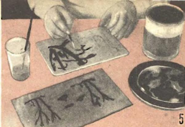
*Altra versione consistente nella applicazione della riserva una volta che il disegno sia stato trasferito sulla lastra di metallo da incidere. Tenere presente che questo sistema è valido solamente quando il disegno sia molto semplice ed a contorni netti. In primo piano, due lavori, pronti per essere immersi nel bagno di incisione.*
