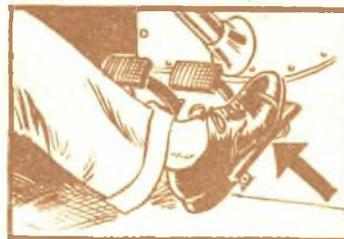
Se l'acceleratore viene premuto completamente prima che il motore si sia avviato, la fase di compressione nei cilindri assorbirà uno sforzo notevole dal motorino di avviamento e dall'accumulatore. Viceversa, l'acceleratore deve essere premuto a fondo se si noti un ingolfamento di benzina nel carburatore. In condizioni normali l'acceleratore deve essere premuto soltanto, e gradualmente, dopo che il motore abbia accennato a compiere da sé i primi giri.
