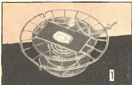
*Pulitura della lastra, con lana di acciaio etri-
