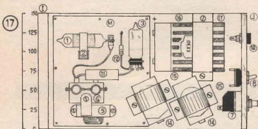
Distribuzione delle parti nell'interno dell'apparecchio, sul rettangolo G di legno, che adempie alle funzioni di chassis; le lettere ed i numeri indicano le varie parti per facilitarne il riconoscimento dallo schema elettrico; « M », è la piastrina metallica che serve da schematura della sezione del contatore e che serve anche da massa comune. Nello stabilire la posizione reciproca delle parti, fare riferimento alla scala centimetrata che è applicata alla estremità sinistra.
