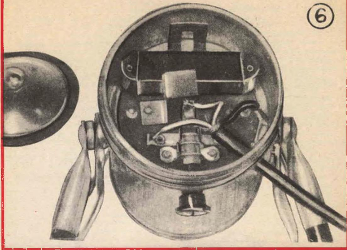
Parziale veduta delle connessioni dei vari conduttori del cavetto quadripolare, alla lanterna modificata: è importante accertare che la polarità della batteria della lanterna stessa sia rispettata, in quanto la sua tensione deve essere inviata al complesso elettronico, del quale alimenta le griglie controlla ed eccita il microfono
