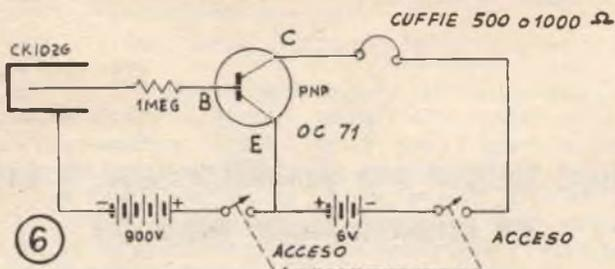
Anche nella più semplice espressione di contatore, non poteva essere trascurata la possibilità di impiego dei transistor ossia di quei componenti semiconduttori che in moltissimi campi hanno preso il posto alle valvole. Anche questa volta, infatti, (fig. 6), si tratta di un circuito semplicissimo e con la alimentazione del tubo Geiger provvista per mezzo di batterie a secco, di tensione adatta al tipo del tubo stesso.
