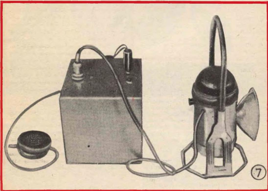
Come si presenta il complesso di trasmettitore vero e proprio, lanterna modificata e microfono, nel suo insieme. Per la lanterna per una portata massima è bene usare lampadinetta con filamento focalizzato e riflettore perfettamente argentato, se possibile deve essere effettuato con la massima cura il puntamento e la messa a fuoco del fascio luminoso.
