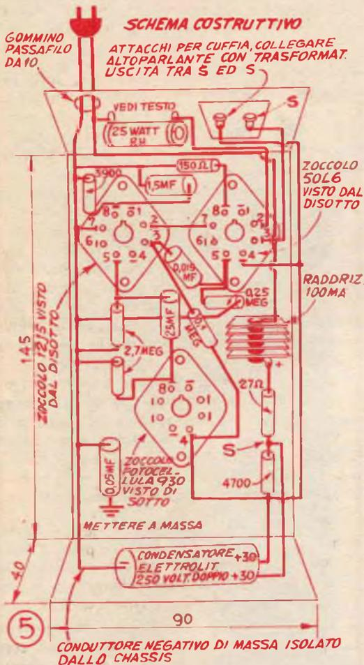
avere la certezza di introdurre completamente in una scatola isolante di plastica o di legno il complesso, ed evitare così qualsiasi contatto elettrico con la massa.
