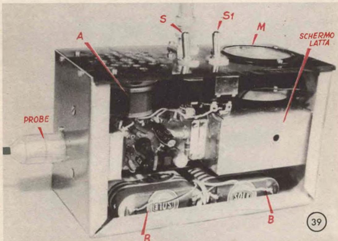
Il contatore Geiger montato. Sul telaio del circuito elettrico è visibile lo schermo (a sinistra) in lamiera. A destra una custodia interna per il «probe»
