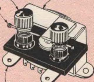
TERMINALI SPINTEROM. TRASFORMATORE CON MONTATO LO SPINTEROM.
