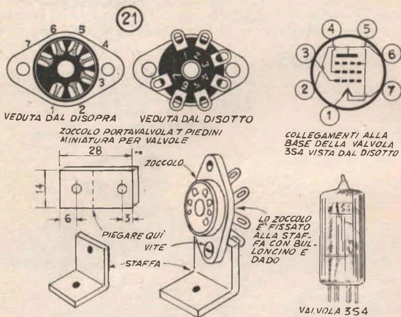
La valvola 3S4, nella sua costituzione interna e con le connessioni ai piedini del suo fondello; lo zoccolo portavalvola visto da entrambe le parti, e dettagli di montaggio del portavalvola per mezzo della staffa angolare
