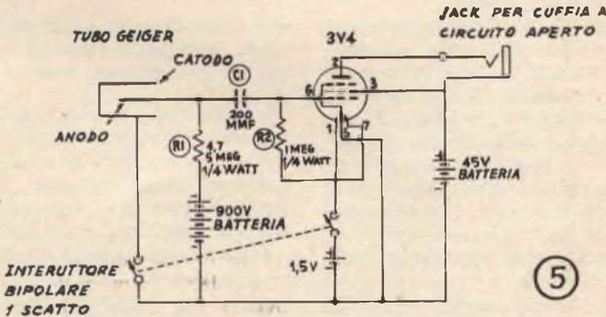
Si tratta del circuito illustrato nella figura 5, il quale differisce dal precedente per il diverso tipo di valvola impiegata e per altri particolari; lo elemento principale della differenza, comunque si basa sul fatto che la alimentazione anodica dello stadio amplificatore a differenza del circuito precedente viene prelevata da una batteria apposita e separata; in questo modo, il maggio-
