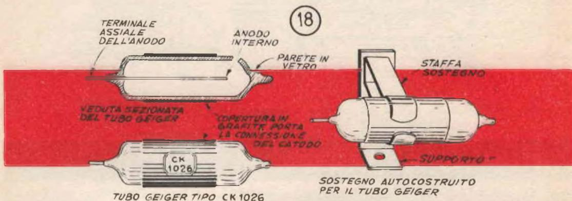
Dettagli della costituzione e delle connessioni relative al tubo Geiger Muller tipo CK 1026 che viene usato in questo apparecchio per la sua buona sensibilità accoppiata con un prezzo più che accessibile, per la staffa di montaggio del tubo, vedere i particolari in basso della fig. 20
