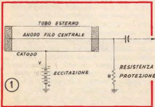
esplicare la sua funzione, si applica tra i suoi due elettrodi, una differenza di potenziale dell'ordine dei 300 ai 1000 ed anche più volt, a seconda del tipo e delle prestazioni per le quali è stato progettato, in maniera che il positivo della tensione in questione sia applica-
