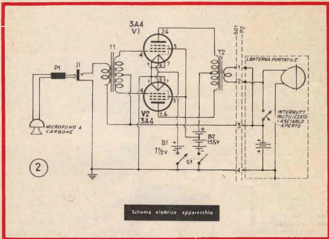
Due valvole miniatura tipo 3A4, sono impiegate in questo complesso in un circuito di amplificazione monostadio in controfase, con accoppiamento di entrata e di uscita, a mezzo di trasformatori, e per la particolare disposizione adottata è possibile avere da tale complesso, eccitato da un microfono a carbone un livello audio di 2 watt circa. In queste condizioni, quando il segnale di bassa frequenza viene inviato ad una normale lan-
