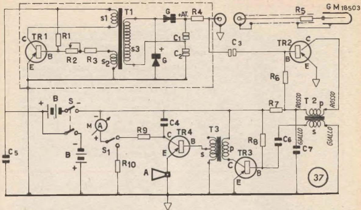
fornita dal tubo rivelatore fino a renderla audibile in altoparlante. Contemporaneamente alla indicazione acustica è stata prevista e realizzata una misura visiva data dallo strumento M. Il circuito dove è inserito M, un milliamperometro da pannello, agisce in modo che questo segni il valore medio degli impulsi in arrivo.
