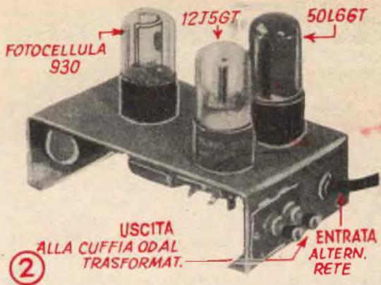
Disposizione delle parti principali, sul telaio costruito, del complesso ricevitore e traduttore del fascio di luce modulata
