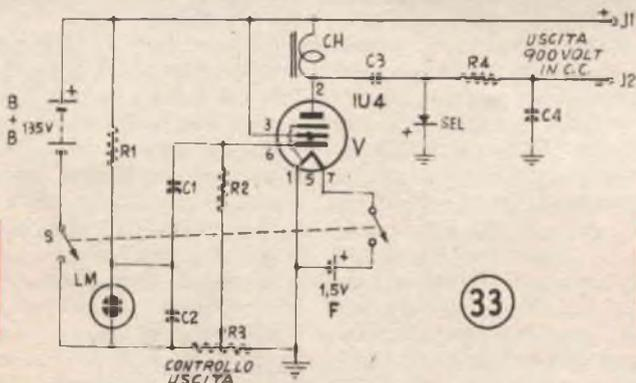
**E**cco un circuito di alimentazione di alta tensione adatto per la eccitazione di un tubo Geiger di tipo che esiga una tensione di 900 volt per funzionare; si tratta di
