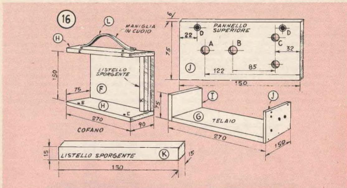
Dettagli costruttivi della cassetta di legno destinata a contenere il contatore
