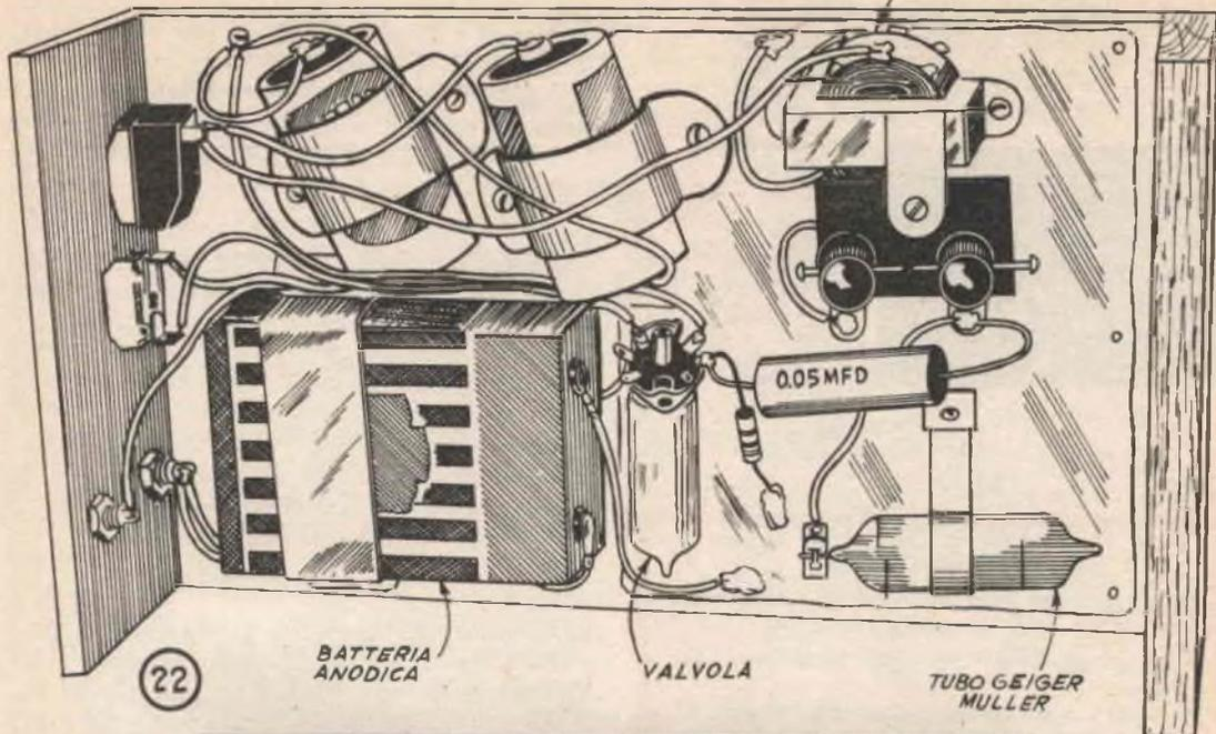
Dettagli ingranditi delle connessioni pratiche alle varie parti e della disposizione delle parti stesse sul telaio di legno
