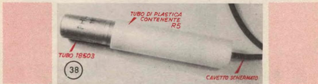
Il « probe » con il tubo 18503 collegato con cavetto schermato all'apparecchio
