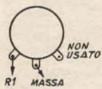
TRANSISTOR DI POTENZA TR1-TR4 VISTI DI SOTTO
