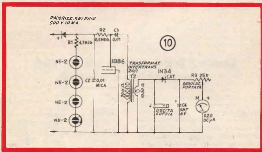
Per soddisfare tutte le esigenze, viene poi fornito nella fig. 10 lo schema elettrico semplificato di un contatore privo di qualsiasi amplificazione ma che è in grado invece di fornire anche una indicazione quantitativa del livello delle radiazioni mediante la deflessione dell'indice di uno strumento. E naturalmente possibile anche la segnalazione sonora mediante un auricolare magnetico di
