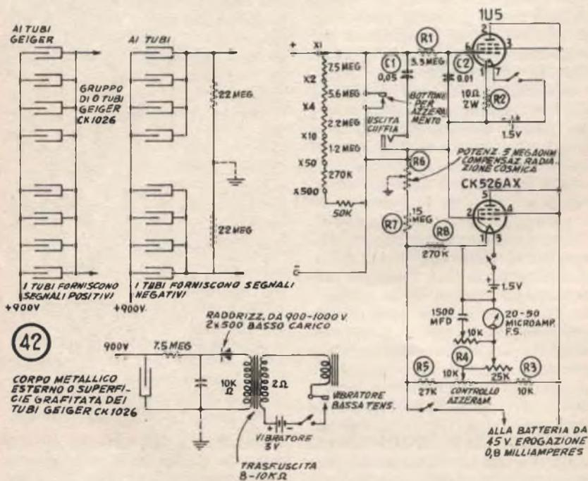
del bulbo della valvola 1U5, per il fatto che questo tubo non è originariamente concepito per una funzione elettrometrica in cui dette tracce di gas sono indesiderabili, ad ogni modo, dopo poche ore di funzionamento della valvola in condizioni normali ossia con il fi-
