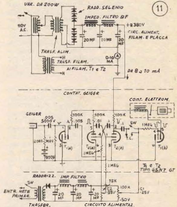
essere munito di un contatore di tempo, o contasecondi, del tipo fotografico che possa essere utilizzato ad attivare o disattivare il complesso mettendolo in condizione di funzionare per il tempo voluto per il rilevamento. L'operatore potrà ispezionare successivamente il complesso già spento e potrà rilevare il numero di impulsi, che saranno stati registrati dal numeratore elettromeccanico stesso.
