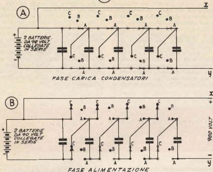
volt. Il commutatore usato è della Geloso o della GBC, a bassa perdita da tre posizioni e nove vie, una delle quali come si vede, risulta inutilizzata; i condensatori sono da 0.5 o da un microfarad a carta ad elevatissimo isolamento e minima perdita eventualmente impregnati di olio. Il circuito facilmente realizzabile in una scatola di plastica con connessioni bene isolate su basette di polistirolo prevede tre posizioni del commutatore; nel-
