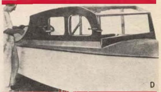
Applicazione sulla struttura portante della copertura di una delle fiancate della cabina: il pezzo, può essere unico, e va ancorato alla struttura, mentre la colla e le viti fanno presa, con morsetti da falegnami
