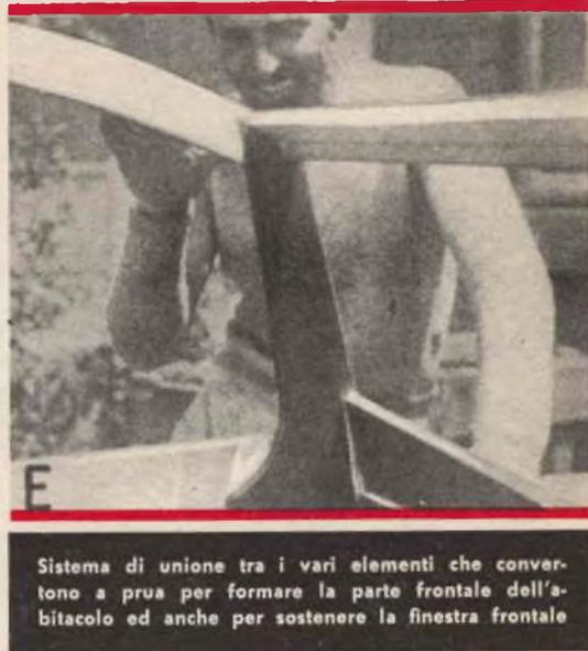
Sistema di unione tra i vari elementi che convertono a prua per formare la parte frontale dell'abitacolo ed anche per sostenere la finestra frontale
