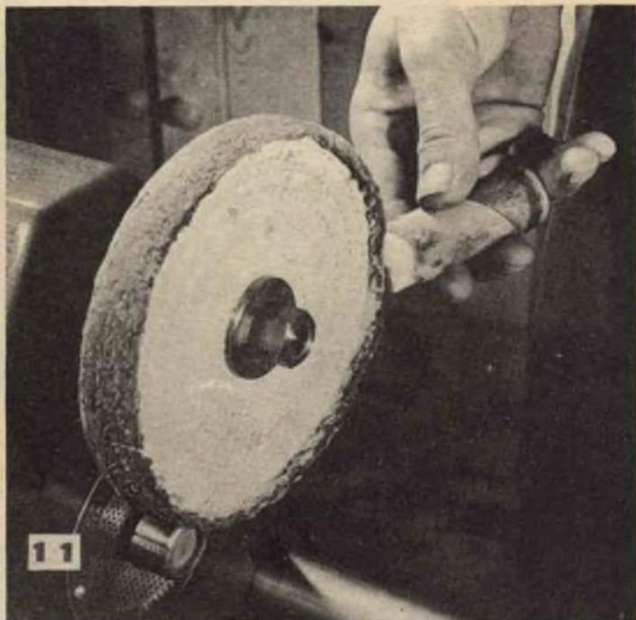
Per ridurre l'azione abrasiva di una ruota, applicare sul suo margine un poco di grasso, di quello a bastoncino usato dai meccanici, ogni certo numero di minuti di lavoro con la ruota stessa; è anzi da dire che una ruota di tela, caricata con polvere molto fine ed ingrassata nella maniera citata, potrà oltreché completare le operazioni di rifinitura, iniziare anche la lavorazione di pulimentatura impartendo al pezzo in lavorazione, un lustro già più che sufficiente.
