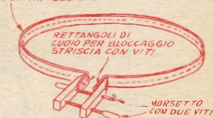
ancora il morsetto è del tutto allentato, in maniera che la pressione esercitata dal complesso, possa essere aumentata notevolmente quando il morsetto sia stretto a fondo, sia per compensare il naturale leggero cedimento della stoffa della fettuccia e sia per un ulteriore assestamento e ravvicinamento dei pezzi da unire.
