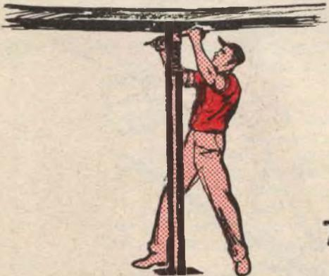
Un martinetto può essere usato con vantaggio per applicare una forza notevole in qualsiasi direzione, quando sia disponibile un punto di appoggio abbastanza solido, in posizione diametralmente opposta a quella del punto in cui la forza va applicata
