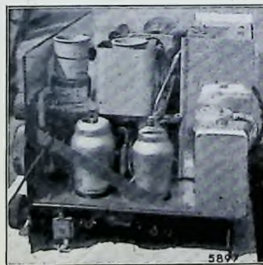
Abb. 7. Gerät von der rechten Seite mit Spulen für 14-MHz-Band. Links Mischröhre, in der Mitte die erste Oszillatorröhre, rechts daneben der ZF-Oszillator mit dem dazugehörigen Abschirmkasten
