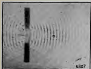
Abb. 3. Richtwirkung der in einem Wellentank erzeugten Wellen bei 7000 Hertz
