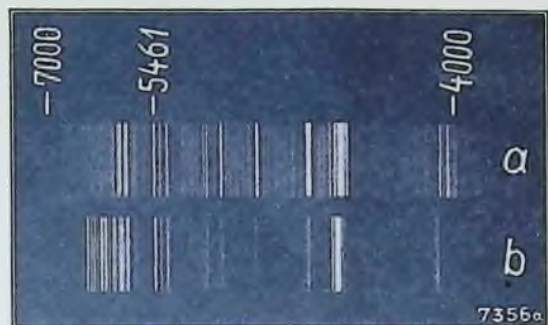
Abb. 6. Spektrum der vom Zeitmarkengeber ZRE 2 gelieferten Strahlung auf ortho- (a) und panchromatischem (b) Negativmaterial. Wellenlängen in Å. E.; 1 Å. E. = 10^{-7} mm, 5461 Å. E. = grüne Hg-Linie.
