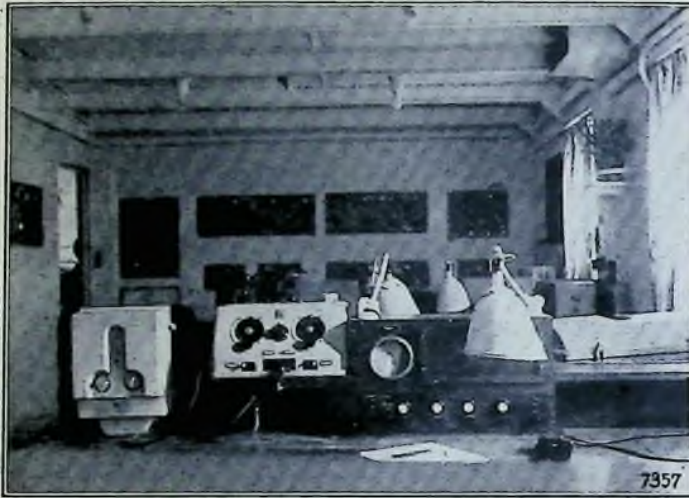
Abb. 1. Die Seefunkstelle „Wilhelm Gustloff“, vorn Empfänger, hinten in die Wand eingelassene Sendegeräte
