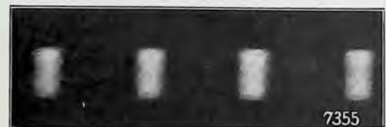
Abb. 5. Mit Schwenkkamera aufgenommene Zeitmarken; Zeit- abstand zwischen zwei Marken = \frac{1}{50} Sekunde
