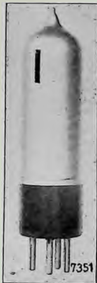
Abb. 1. Außenansicht des Zeitmarkengebers ZRE 2 Hersteller: Fa. E. Gundelach, Gehlbarg/Thür. Wald
