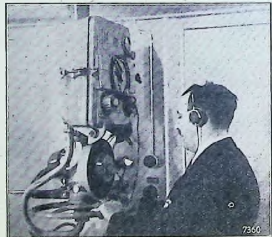
Abb. 4. Funkoffizier am Funkpeiler bei der Aufnahme der Funkbeschießung (Feststellung der Kurve des ständig gleich bleibenden Peilfehlers, der sich durch Schiffsablenkungen ergibt)
