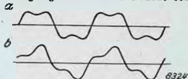
Abb. 6. Einfluß der Phase auf das Schwingungsbild
