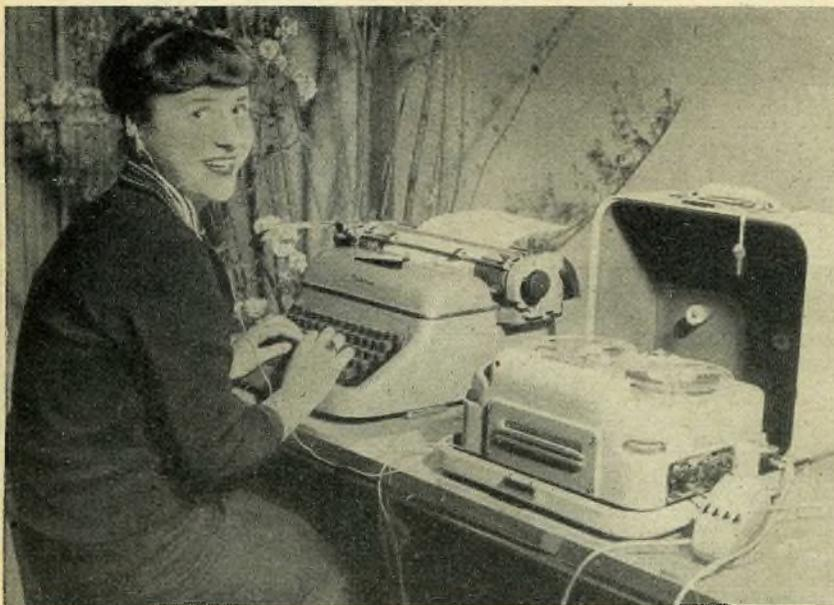
„diktina“ heißt das Banddiktiergerät BG 21 vom VEB Meßgerätewerk Zwönitz zur zeitsparenden Aufnahme und Wiedergabe von Diktaten, Konferenzen, Telefongesprächen usw. Bei einer Bandgeschwindigkeit von 6,35 cm/s reicht der Frequenzbereich von 500 bis 3500 Hz.
