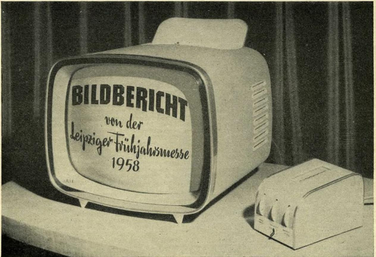
▲ Die Sensation der Technischen Messe war das Fernsehgerät „Alex“ von VEB Stern-Radio Berlin. Nicht nur die Kleinheit des formschönen Gehäuses gefiel, sondern auch, daß das Gerät mit nur 10 Röhren + 3 Dioden ein einwandfreies Bild wiedergibt. Der Fernbedienungsteil ermöglicht UKW-Empfang.
