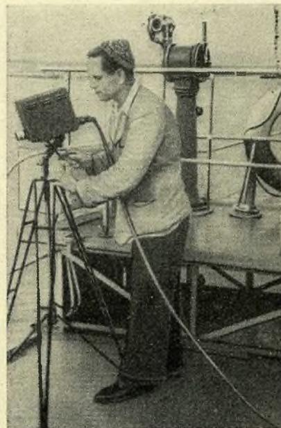
Bild 3: Eine Fernsehkamera für den industriellen Einsatz.
