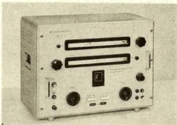
Schon in der neuen, modernen Linie gestaltet ist der UKW-Frequenzmesser Typ 3010 des VEB Funkwerk Erfurt. Er gestattet direkte Frequenzmessungen im Bereich von 20 bis 300 MHz
