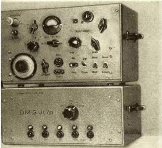
Bild 5: Gesamtansicht des transportablen Notensenders, bestehend aus Senderteil und Stromversorgungsteil (Bild oben)
