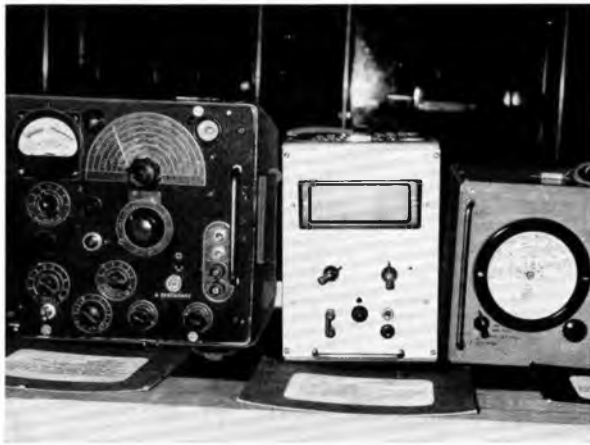
Bild 3: Reichhaltig war das Angebot an Eigenkonstruktionen von Meßgeräten. Unser Bild zeigt in der Mitte ein Vielfachmeßgerät (Spannung, Strom, Widerstand) mit Ziffernanzeige. Bestückt ist das Gerät mit 58 Transistoren und einer Röhre
