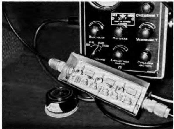
Bild 6: Unser Bild zeigt einen mit Halbleiter-Bauteilen bestückten Antennenverstärker, wie er z. B. für Weitempfangsversuche beim Fernsehen verwendet werden kann Fotos: Schubert (6)
