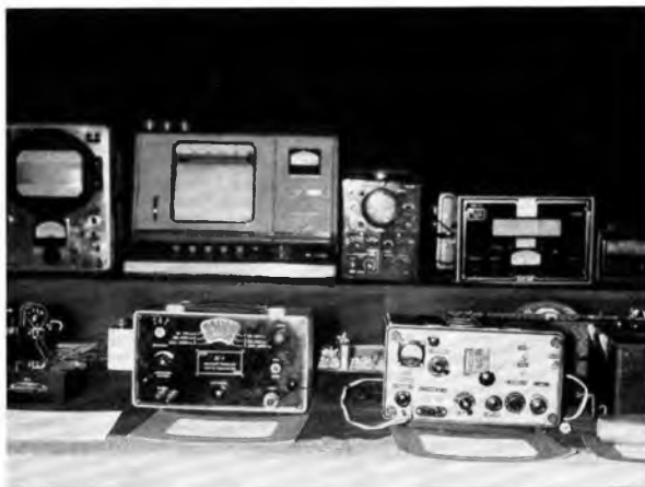
Bild 5: Unser Bild zeigt aus der Abteilung „Meßgeräte“ links unten einen Tongenerator für den Frequenzbereich 20 Hz bis 20 kHz, rechts unten ein kombinierter HF-NF-Signalgenerator
