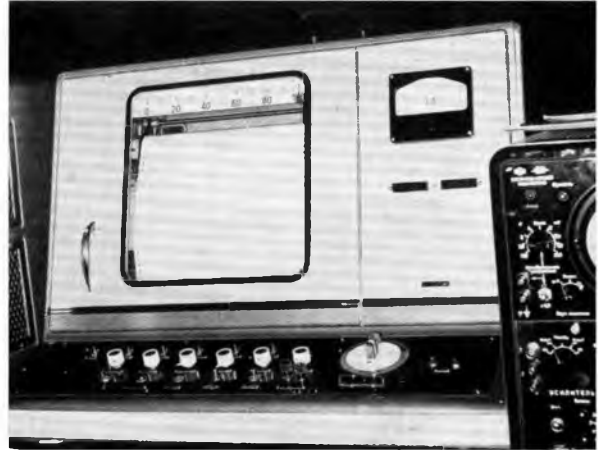
Bild 2: Von einem Kollektiv entwickelt wurde dieser Kennliniensreiber für Tunnelioden. Für die angeschlossene Tunneliode werden die Parameter eingestellt und dann selbsttätig der Kennlinienverlauf aufgezeichnet
