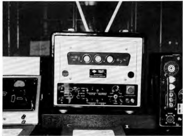
Bild 4: Mit drei elektronischen Ziffernanzeigeröhren bestückt ist dieses Vielfachmeßgerät aus Lwow, konstruiert von einem Kollektiv des Polytechnischen Instituts. Es können damit Spannungen und Widerstände gemessen werden
