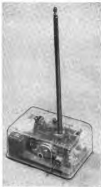
Bild 2: Das für stationären Betrieb bestimmte Mustergerät wurde in einer Plastik-Haushaltswarendose eingebaut
