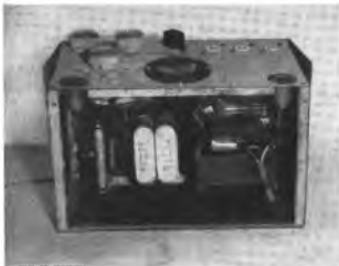
Bild 4: Blick auf das Chassis des Netztesles (Weitere Fotos siehe III. Umschlagseite)
