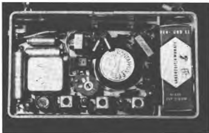
Bild 4: Als Gehäuse für den aufgebauten Transistorsuper wurde ebenfalls das des Taschenempfängers „Stärchen“ benutzt Bild 10: Schaltung der Misch-Oszillatoren, der ZF-Stufen und des Demodulators (Bild unten)
