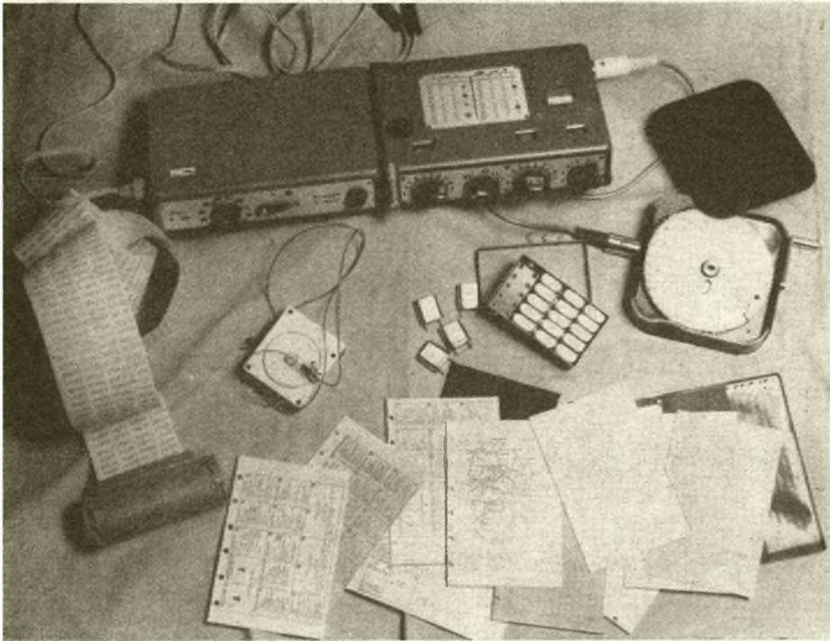
Beim Berliner Gehlen-Militärspion Heinz Fink sichergestellte komplette Agentenfunkausrüstung modernster westdeutscher Bauart. Oben: links Netzteil, rechts Sender; Mitte von links nach rechts: Schlüsselrolle, Wurfantenne, Quarze, Schnellgeber; unten: Spionagebeobachtungsaufträge für den Raum Berlin und Chiffrierungsunterlagen
