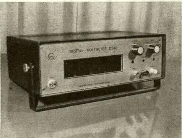
Bild 3: Die Firma Wagner Digital-Elektronik aus Westberlin zeigte ein sehr handliches Digital-Voltmeter. Die Meßbereiche der Ausführung „DS 40“ sind 2 - 20 - 200 - 1000 V, die Meßgenauigkeit ist 0,1 % ± 1 digit vom Meßwert Fotos: MBD/Demme (2), RFT-Pressedienst
