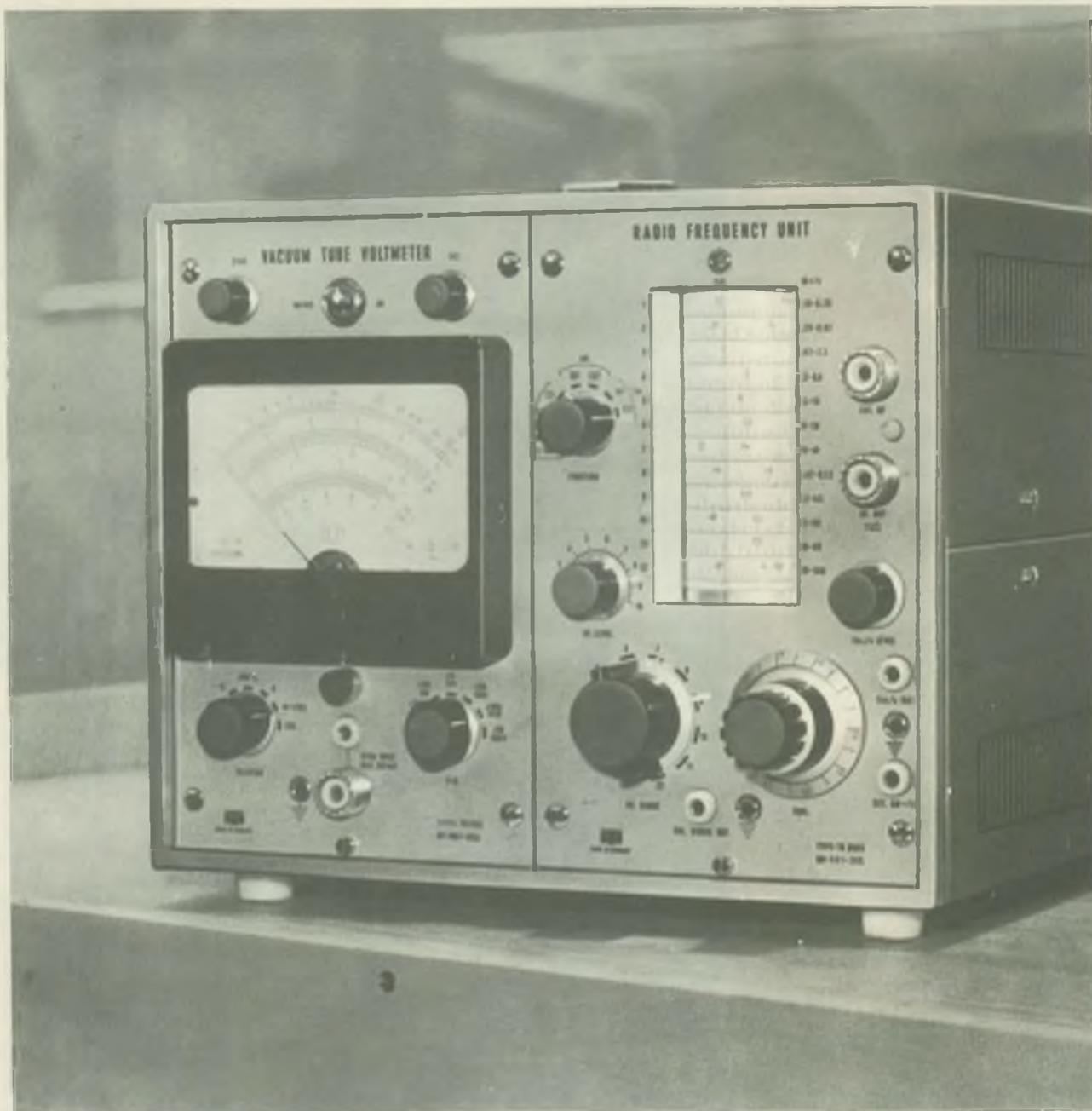
Das AM FM-Rundfunk-Servicegerät „Typ TR-0608“ der Elektronikindustrie der VR Ungarn besteht aus einem Röhrenvoltmeterereinsatz (links) und einem HF-Generatoreinsatz (rechts).
