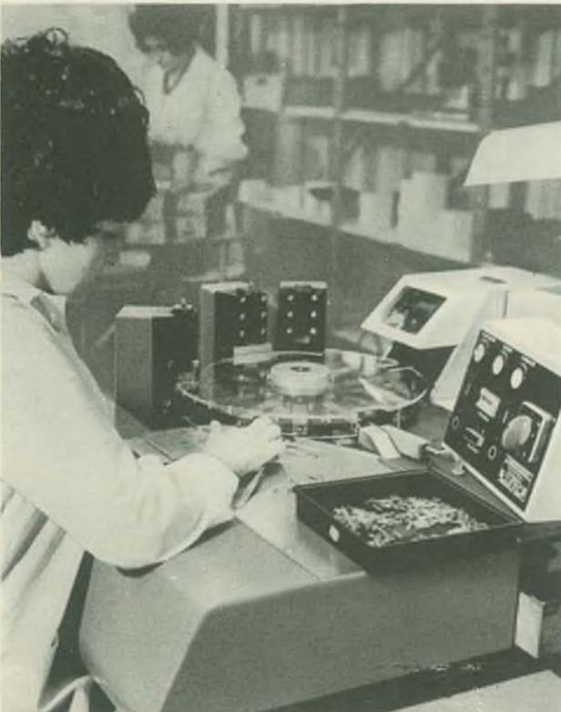
1961 — Seit Anfang des Jahres läuft die Transistorenproduktion an zwei Fertigungsstraßen im neuen Halbleiterwerk Markendorf bei Frankfurt (O.) Produziert werden 1-W-Leistungstransistoren und HF-Transistoren bis 10 MHz. Das Bild oben zeigt die Fertigungsstraße für HF-Transistoren
