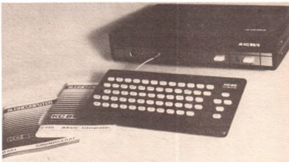
Eine Weiterentwicklung des bekannten Kleincomputers KC 85/2 ist der KC 85/3 mit integriertem BASIC-ROM (VEB Mikroelektronik „Wilhelm Pieck“ Mülhhausen) Foto: RFT-Pressedienst
