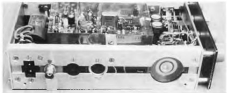
Bild 6: Linke Seitenansicht des geöffneten Geräts. Gut zu erkennen die Rahmenkonstruktion des Chassis. Oben im Bild die PLL-Baugruppe [1]. Die Anschlußbuchsen und der Lautsprecher befinden sich nicht an der Rück-, sondern an der linken Seite des Transceivers. Das ermöglicht bei Mobilbetrieb einen bequemen Ein- und Ausbau.
