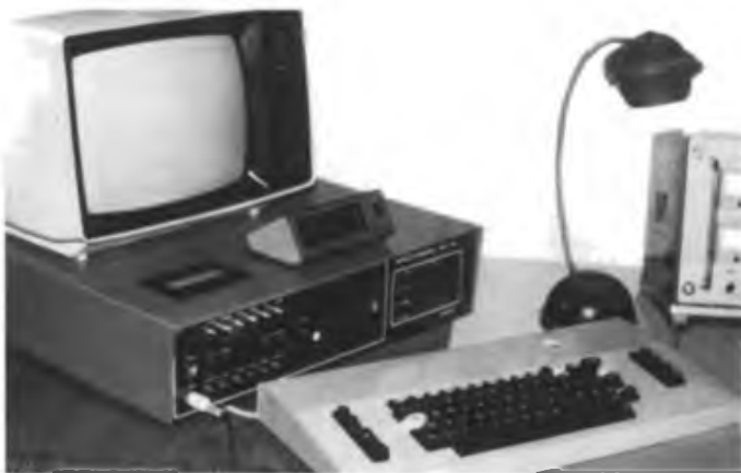
Der Y34ZF-Computer. Er ist mit 64 KByte RAM, einem integrierten Kassettenlaufwerk und einem RTTY-Konverter konfiguriert. In einer der nächsten Ausgaben stellen wir diesen Computer ausführlicher vor.
