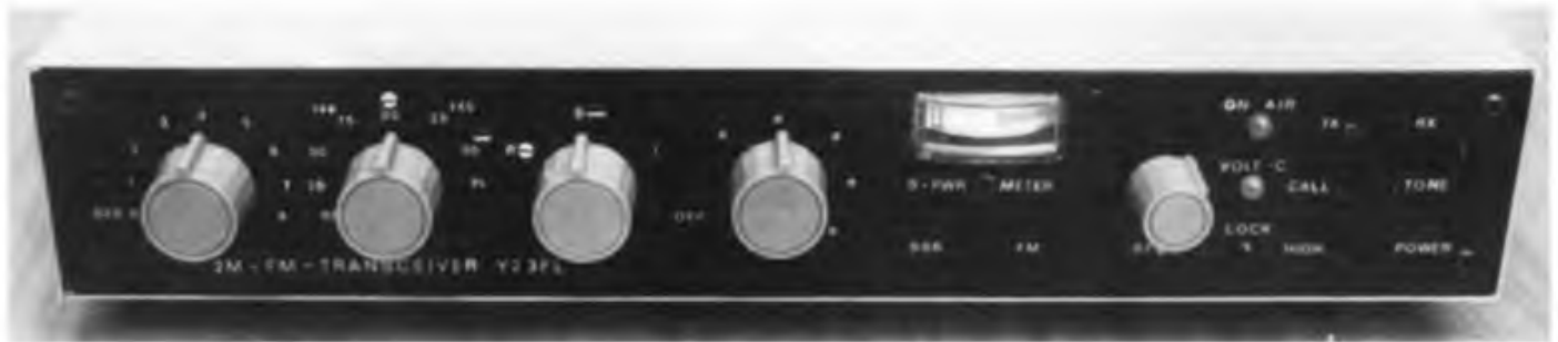
Bild 4: Frontansicht des Transceivers. Links die Bedienelemente des PLL-Oszillators, in der Mitte der Lautstärksteller und das Instrument zur Felstärke- bzw. Leistungsanzeige, rechts Sende/Empfangs-, Rufton- und Leistungs-Umschalter
