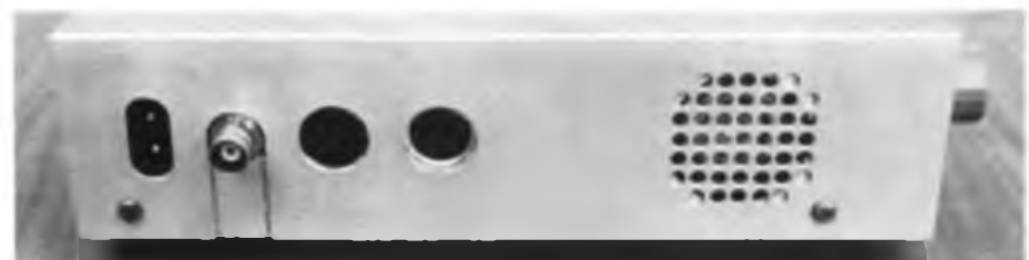
Bild 7: Linke Seitenansicht des betriebsfertigen Geräts. Von links nach rechts: Betriebsspannungs-, Antennen-, Lautsprecher- und Mikrofonbuchse sowie Lautsprecher
