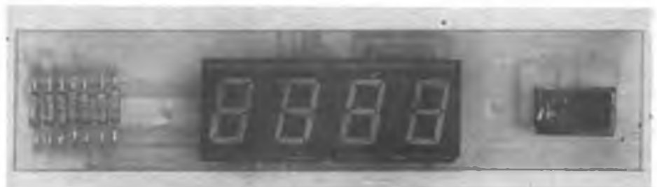
Bild 13: Ansicht der mit den Anzeigen bestückten Leiterplatte
