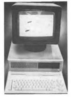
an die Computerarbeit (im Gegensatz zu den bisherigen Kleincomputern) gut erfüllt. Das System ist diskettenorientiert und CP/M-fähig, so kann z. B. PC 1715-Software unter SCP (SCPX) verarbeitet werden. Ein leistungsfähiger BA-SIC-Interpreter unterstützt das Erlemen dieser Programmiersprache. In das RBA-SIC wurden auch vom KC-BASIC bekannte Anweisungen implementiert, so daß derjenige, der bereits das KC-BASIC kennt, kaum Schwierigkeiten haben wird, sich einzuarbeiten.
