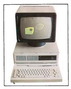
Die komplette Konfiguration des A5105 besteht aus Computergrundgerät, Diskettenspeichereinheit mit Netzgerät und Monitor.
