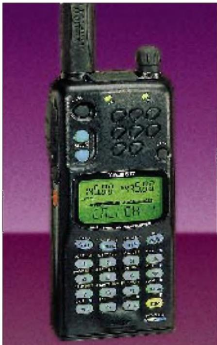
Ein weiteres Feature bietet das Spektrumspektroskop. Ausgehend vom eingestellten Kanal, werden acht Nebenfrequenzen als Symbole dargestellt, die deren Belegungen in Signalstärken anzeigen.
