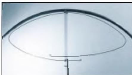
Bild 2: Die Koppelschleife ist oberhalb des Polyamidstabes befestigt
