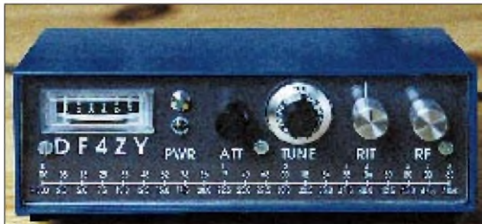
Bild 6: Betriebsbereiter CW-Transceiver für das 40-m-Band mit 2 W Ausgangs- leistung an 50 Ω
