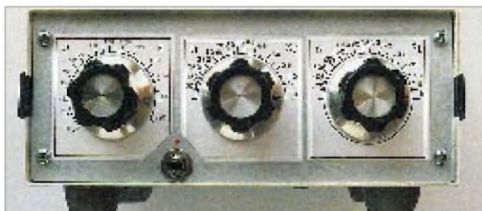
Bild 3: Frontansicht der neuen Rausch-Meßbrücke. Links Meßwert R, in der Mitte X_C , rechts X_L . Unten zwischen R und X_C der Kippschalter für die Betriebsspannung.
