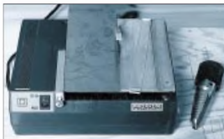
Bild 4: Tischkreissäge mit Hartmetallblatt zum Zusägen von Basismaterial und Plexiglas/Piacryl. Rechts ein Spezialbohrer zur Herstellung größerer runder Durchbrüche
