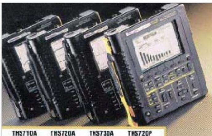
sungen sowie durch die Isolated Channel™-Architektur. Hinter diesem Begriff verbirgt sich die komplette optische Potentialtrennung der Eingänge CH1; CH2 und DMM gegenüber dem Hauptchassis. Folglich dürfen an den Eingängen (CH1, CH2, DMM) Meßobjekte mit verschiedenen Bezugspotentialen (mit entsprechenden „Proben“ bis 600 V gegen Erde) gemessen werden,
