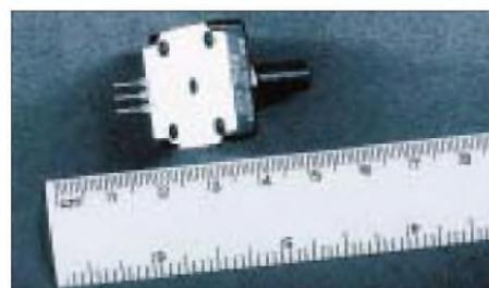
Bild 2: Die mechanischen Abmessungen des Encoders betragen nur wenige Quadratzentimeter. Foto: Autor
