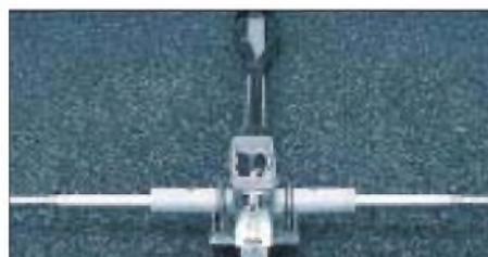
**Bild 2: Das isoliert gehaltene Mittelstück des Strahlers**
