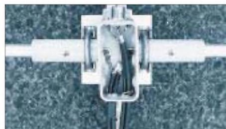
**Bild 4: Blick in die Anschlußdose mit den angeschlossenen Anpaßleitungen**
