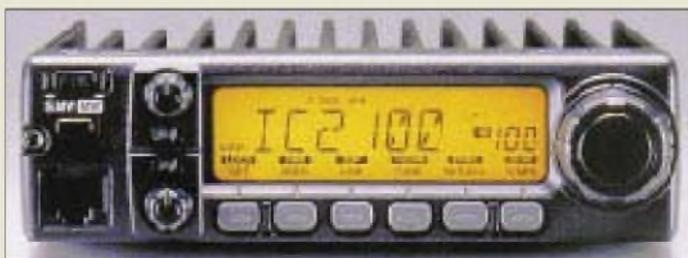
**IC-2100 H: Maximal 55 W HF aus einem 140 mm x 40 mm x 180 mm kleinen Gehäuse**
