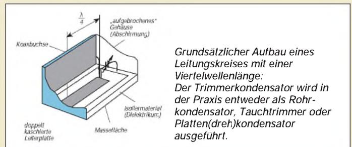
Grundsätzlicher Aufbau eines Leitungskreises mit einer Viertelwellenlänge: Der Trimmerkondensator wird in der Praxis entweder als Rohr-kondensator, Tauchtrimmer oder Platten(dreh)kondensator ausgeführt.
