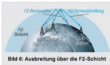
**Bild 6: Ausbreitung über die F2-Schicht**
