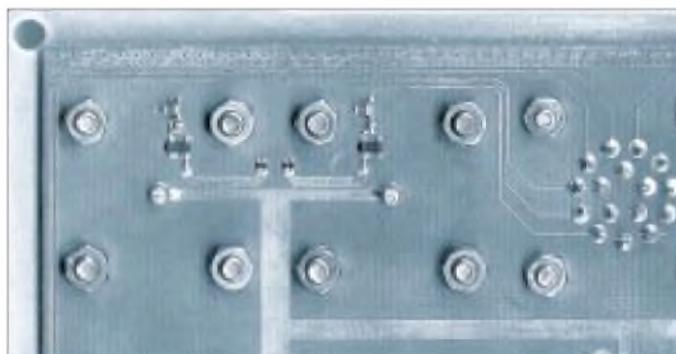
gestrichen, auf die Platine gesetzt und anschließend mit dem Aluminiumwinkel des Mastgehäuses verschraubt. Erst dann erfolgt das langsame Erhitzen der ganzen Konstruktion bis einige Grad über den Schmelzpunkt der Lötpaste – beispiels-
