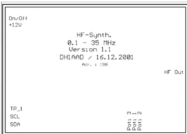
Bild 12: Label für den Deckel des Weißblechgehäuses, das den HF-Teil des Synthesizers aufnimmt (M 1:1).
