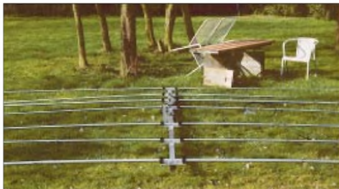
Bild 3: Diese Elementhalterungen garantieren schnelle Montage bei gleichzeitig hoher Stabilität.
