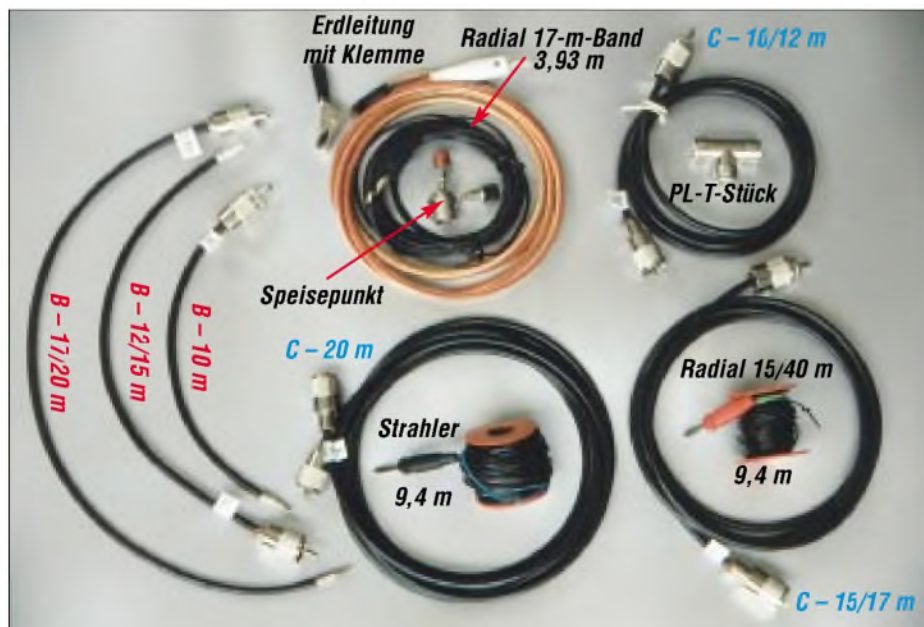
Bild 4: Der Antennen-Anpaßsatz, hier ohne die 7-m-Drähte; Bezeichnungen B und C korrespondierend mit Bild 2 Fotos: DL8LBK
