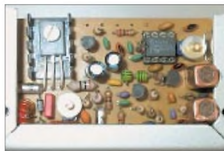
Bild 11: Rechte Gehäusesseite mit Blick auf die Senderplatine Fotos: DL2BD
