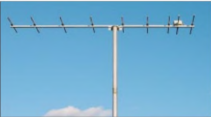
Bild 1: Die 9-Element-Yagi mit 1,50-m-Boom
