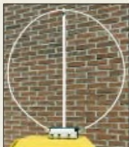
Die knapp 1 m große portable Loopantenne arbeitet von 10...80 m.
