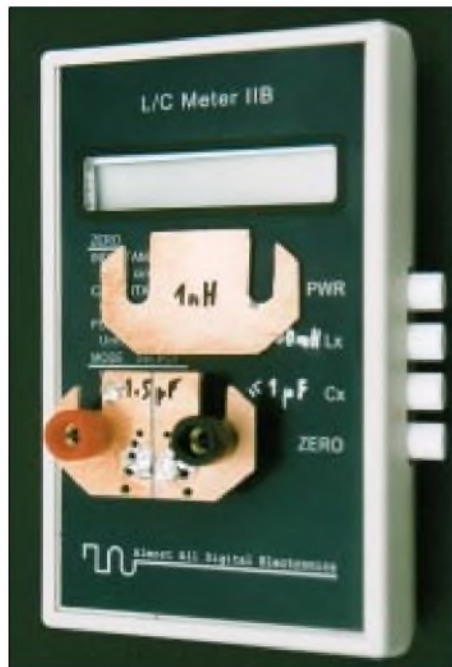
Bild 1: Hilfsmittel zum Ausmessen kleiner Kondensatoren und Spulen; die im Bild sichtbaren Löcher sind ohne Bedeutung.
