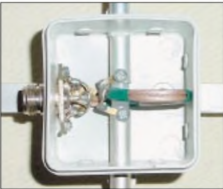
Bild 2: Anpaßleitung mit 75-Ω-Teflonkabeln RG 179 in der Strahlerdose
