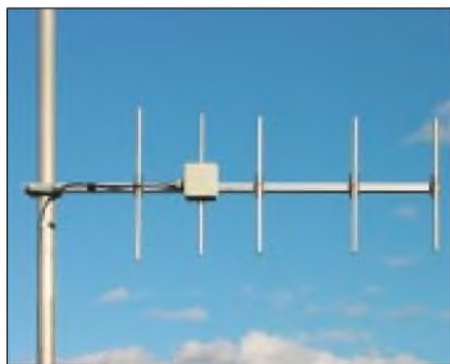
Bild 5: Vormastmontage bei der 5-Element-Yagi
