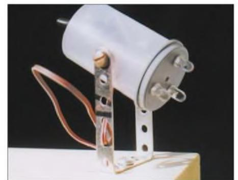
Bild 3: Die Halterung gestattet das Drehen und Schwenken des Spots. Foto: DL1MK
