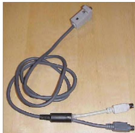
Bild 4: Das fertige Y-Kabel
