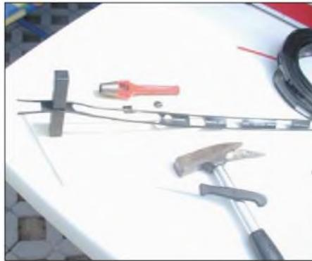
**Bild 7:** Heraustrennen der Mittelstege des Wireman-Kabels
