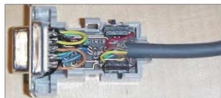
Bild 5: Ansicht der Platine im Steckergehäuse
