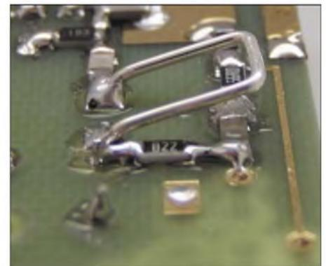
**Bild 16: Die Detailansicht mit der Spule L2 verdeutlicht deren U-Form. Fotos: OK2XDX**
