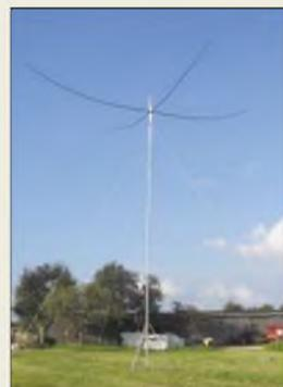
Mit einer Transportlänge von nur 1,2 m und einer Masse von 5,5 kg eignet sich der Spiderbeam sehr gut für Portabelbetrieb, zumal deren Aufbau durch eine einzelne Person möglich ist.
