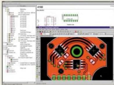
Entwickler komplexer Platinen können nun blinde und durchgehende Layer-Verbindungen (Blind&Buried-Vias) herstellen, die auch vom Autorouter und bei der Überprüfung der Designer-Regeln berücksichtigt werden.
