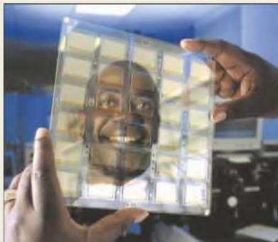
Die auch unter dem Namen OLED – organische LED – entwickelten Produkte ermöglichen einen weiten Betrachtungswinkel sowie Bilderdarstellungen in Videoqualität und gestatten die Herstellung sehr flacher, heller Displays. Mit dem Beginn der Serienproduktion ist in der nächsten Zeit zu rechnen.
