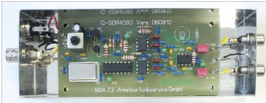
Bild 1: IQ-SDR-Kit von DM2CQL [1], hier in einer Variante für den Empfang von 3,500 bis 3,524 MHz im 80-m-Amateurband; bei entsprechender Nachfrage kann der FA-Leserservice weitere TTL-XOs für andere interessierende Frequenzen (160...40 m) fertigen lassen.
