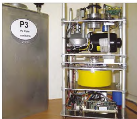
Bild 2: Innenansicht des Peilers
