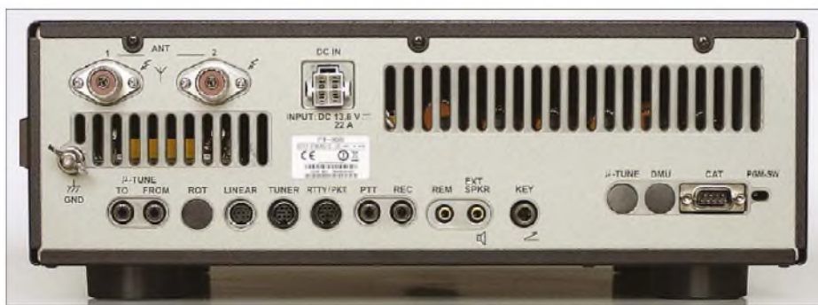
Bild 2: Rückansicht des FT-950. Der Lüfter befindet sich im Innern; die erwärmte Luft strömt durch die Schlitz. Die Beschriftung der Buchsen ist auch bei ungünstiger Beleuchtung gut zu lesen. Man beachte die Stopfen in drei der Buchsen.
