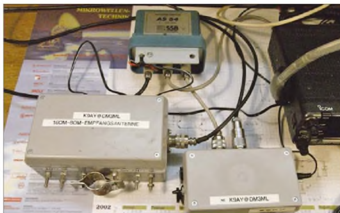
Bild 13: Versuchsaufbau von Anschlusskasten und Steuergerät der K9AY-Empfangs- antenne am Messplatz Fotos: DM3ML
