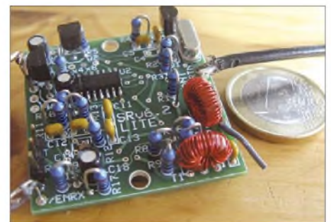
Bild 2: Softrock SRv6.2 Lite für 80 m; der sehr kleine Direktmischer überstreicht etwa den Bereich 3505 bis 3550 kHz.
