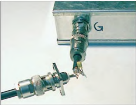
Bild 19: Messung des Nebenschlussverhältnisses an einem Abblockkondensator mithilfe des FA-NWT; auf kürzestmögliche Leitungsführung ist zu achten!
