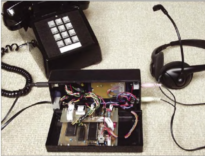
Bild 1: Der eher unscheinbare Verschlüsseler, hier im geöffneten Zustand, wartet mit inneren Werten auf. Per Tastendruck lässt er sich einfach in eine bestehende Verbindung einschleifen und gewährleistet dann die abhörsichere Sprachübertragung.
