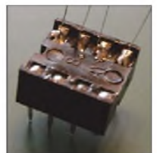
Bild 4: Im Schritt 2 sind die Verbindungsdrähte in die Kontakte der Fassung zu löten.
