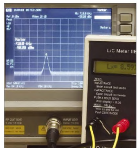
Bild 12: Die Messung der Induktivität erfolgt mit dem LC-Meter von AADE unterhalb 1 MHz; hier ist für L = 8,5 \mu\text{H} eine Messfrequenz von f = 710 kHz abzulesen; bei 1 \mu\text{H} ergab sich f = 750 kHz.
