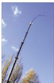
Bild 4: Oberteil der Vertikalantenne mit L-Verlängerung
