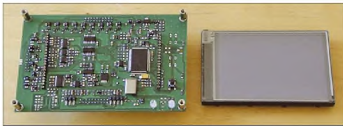
Bild 4: Die CPU-Platine ist fast nur mit SMD-Bauteilen bestückt. Der Tastbildschirm wird aufgesteckt.
