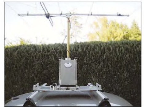
Bild 3: Antenne und Plattform des Peilers
