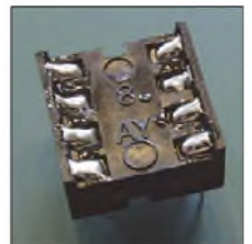
Bild 3: Das vorsichtige Verzinne der Kontakte der IC-Fassung bildet den Schritt 1 zum Adapter.
