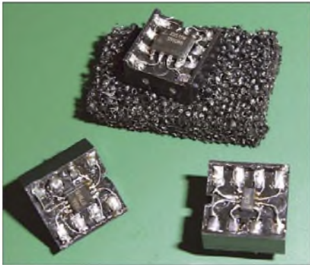
Bild 1: Die auf DIL-Fassungen verdrahteten SMD-ICs lassen sich problemlos in Versuchsaufbauten integrieren.
