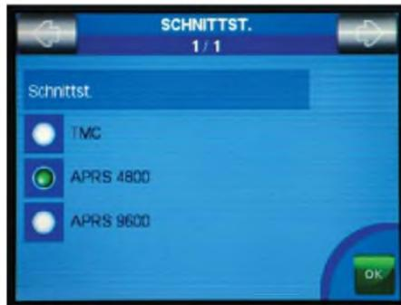
Bild 6: Einstellen der Konfiguration zur Kommunikation mit dem TM-D710 – Schnitst. – APRS 4800 – OK
