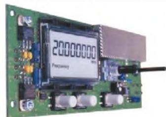
Bausatz für einen DDS-Oszillator, der zwischen 0,1 Hz und 20 MHz Sinus- und Rechtecksignale erzeugt! Vorteilerfaktor für Einsatz mit PLLs sowie Offset-Frequenzen sind programmierbar. Dazu Wobbelfunktion sowie Speichermöglichkeit für 10 Frequenzen.
