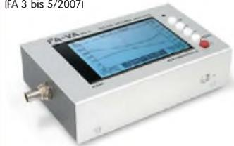
Wobbelnder Stand-Alone-Analysator für den Frequenzbereich von 50 kHz bis 160 MHz mit vektoreller Anzeige auf Grafikdisplay, USB-Anschluss. Bausatz mit SMD-bestückter Platine, Display, Gehäuse, Ladeelektronik und Baumpappe.
