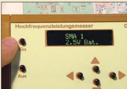
Der hier beschriebene HF-Leistungsmesser, der konsequent auf Batterie-stromversorgung ausgelegt ist, zeigt nicht nur die Leistung, sondern auch Dämpfung, Verstärkung und Hochfrequenzspannung auf einem Display numerisch an. Die Messung selbst erfolgt durch einen Messkopf, der fertig gekauft oder selbst gebaut werden kann.
