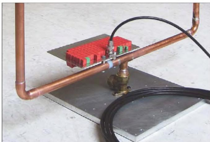
**Bild 15:** Ausführung einer freitragenden Rahmenantenne aus 15-mm-Kupferrohr für bestmöglichen Fernempfang; das freie Ende ist mechanisch mit einem runden Kunststoffisolator fixiert, zur Abstimmung auf Resonanz dienen einige sehr verlustarme FKP-2-Kunststoffkondensatoren; die Leerlaufgüte liegt bei  $Q_0 = 114$ .
