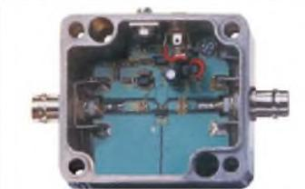
Bausatz mit Gehäuse für einen Breitbandverstärker für 10 MHz bis 2 GHz MMIC-bestückt, etwa 19 dB Verstärkung, Ausgangsleistung 1 GHz bei 1-dB-Kompression typ +20 dBm (100 mW). BNC-Buchsen. UB 12-18 V DC, 110 mA.
