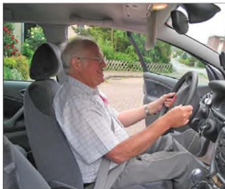
**Bild 1:** Das Mikrofon ist mit einer Klammer am Sicherheitsgurt befestigt.
