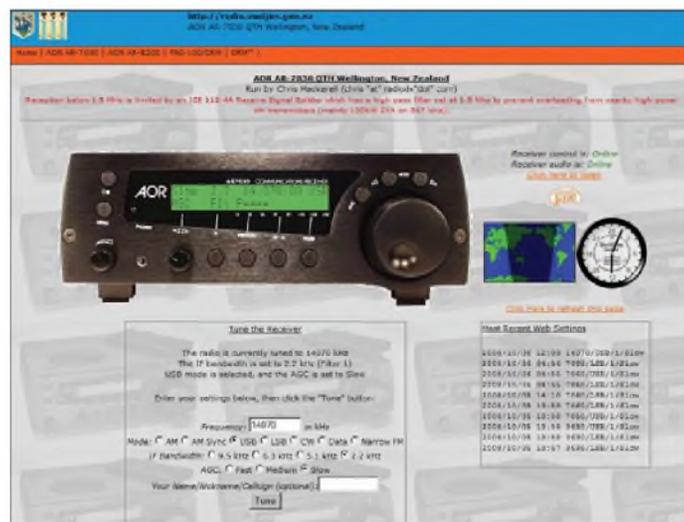
Ohr bei der Flugfunkstation *Auckland Radio* in SSB gelandet. Wenn wir auf *Audio is Online* klicken, öffnet auf dem Bildschirm ein Fenster mit der Frage, ob die Datei NRD515.mp3.m3u geöffnet oder gespeichert werden soll. Hier öffnen wir und im PC startet der für die Wiedergabe zuständige Multimedia-Player. Das ist meistens der Windows Media-Player, doch auch WinAmp oder QuickTime sind geeignet.
