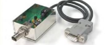
**Bausatz mit Richtkoppler TDC-10-1, bearbeitetem Weißblechgehäuse, 2 BNC-Einbaubuchsen, 1 BNC-Einbaustecker Komplettbausatz BX-151 28,50**
