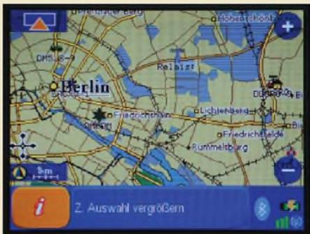
Das Navigationsgerät geosat 5 Blu APRS zeigt im Zusammenwirken mit einem APRS-fähigen Mobilfunkgerät von Kenwood nicht nur die eigene aktuelle Position, sondern auch die Position anderer APRS-Stationen an.
