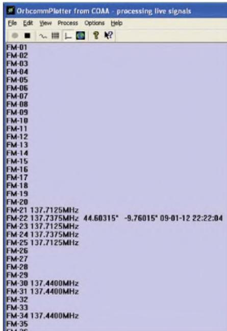
**Bild 3:** Das Programm merkt sich automatisch die Frequenzen der empfangenen Satelliten.
