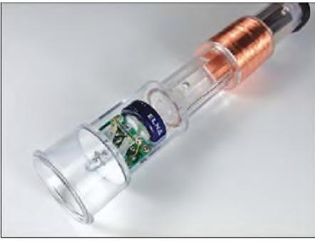
**Bild 70:** Inneres einer induktiv betriebenen Taschenlampe mit Doppelschichtkondensator als Energiespeicher
