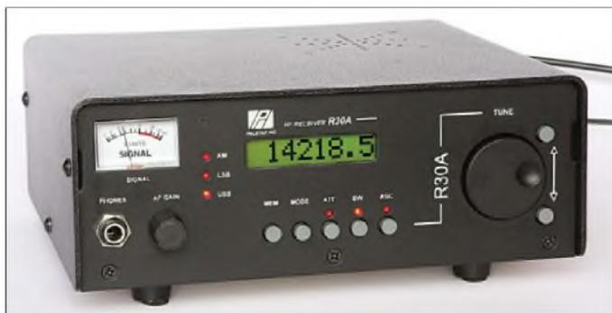
**Beschränkung auf das Wesentliche: Der konventionell aufgebaute Doppelsuper empfängt von 100 kHz bis 30 MHz in SSB und AM.**
