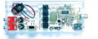
PLL-Prüfgenerator für Abgleich und Reparatur von UKW-FM-Empfängern (UKW-Tuner, Autoradios, tragbare Radios). Frequenzbereich 87,5 bis 108 MHz Bausatz mit Gehäuse **BE-007 31,50**
