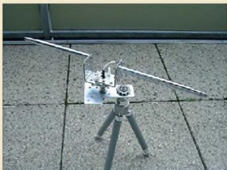
Aus zwei Teleskop-Antennenstäben und Material aus dem Baumarkt entsteht mit wenig Aufwand ein drehbarer Dipol für das 6-m-Band, der leicht transportabel ist und sich an einer Balkonbrüstung oder – wie im Bild gezeigt – auf einem Fotostativ montieren lässt.
