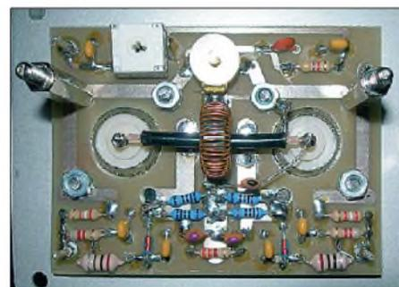
**Bild 3:** Ansicht der bestückten Messkopflatine mit installierten Buchsen
