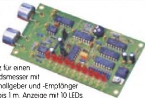
Bausatz für einen Abstandsmesser mit Ultraschallgeber und -Empfänger für 0,1 bis 1 m. Anzeige mit 10 LEDs. Stromversorgung 10-15 VDC, 20 mA.
