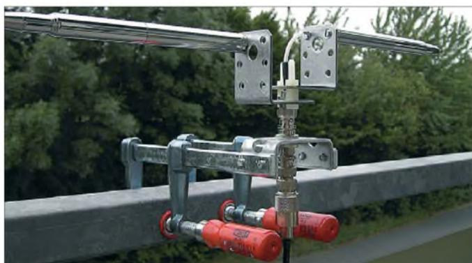
**Bild 1:** Fertig montierte Antenne mit Balkonhalterung; durch die BNC-Steckerverbindung ist die Antenne drehbar.
