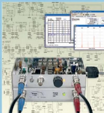
Von vielen Lesern bereits erwartet und in Kürze als Bausatz verfügbar: der Spektrumanalysator-Vorsatz zum FA-Netzwerktester. Er kann im Frequenzbereich von 0,1 MHz bis 75 MHz (opt. auch im 2-m-Band) Signalspektren mit einer minimalen Bandbreite von 300 Hz auflösen. Der Vergleich mit einem FSL3-Screenshot (Rohde & Schwarz) zeigt Pegelabweichungen von unter 1 dB. Konzept und Schaltungsdetails stellen wir ab S. 514 vor. Foto, Screenshots: Red. FA Schaltplan: DM2CMB
