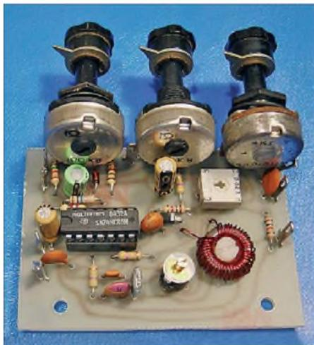
Bild 1: Ansicht des kompletten Wobbelzusatzes mit dem HCMOS-Schaltkreis
