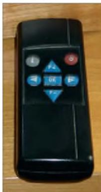
**Bild 2:** Einfacher geht es nun wirklich nicht mehr! Diese Fernbedienung eines Hotel-Fernsehgerätes ist einfach und unkompliziert zu betätigen. Sieben Bedienelemente und eine gute Strukturierung der Benutzeroberfläche machen die Handhabung auch noch bei gewissen Ablenkungen möglich ...
