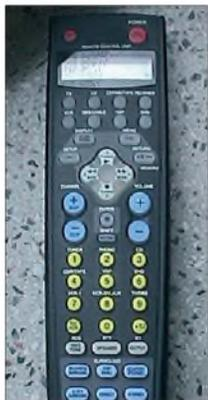
**Bild 1:** Fernbedienung eines Fernsehgerätes; aufgrund der großen Anzahl der Bedienelemente (51!) sowie der fehlenden Systematik und Struktur fällt einem die Bedienung nicht ganz so leicht. Dass dies auch anders geht, beweist Bild 2.
