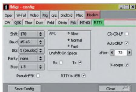
Bild 2: RTTY-Modem-Einstellung
