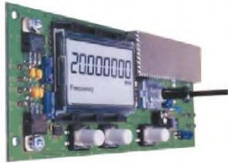
Bausatz für einen DDS-Oszillator, der zwischen 0,1 Hz und 20 MHz Sinus- und Rechtecksignale erzeugt. Vortreiberfaktor für Einsatz mit PLLs sowie Offset-Frequenzen sind programmierbar. Dazu Wobbelfunktion sowie Speicherfähigkeit für 10 Frequenzen. Alle SMD-Bauelemente sind vorbestückt.
