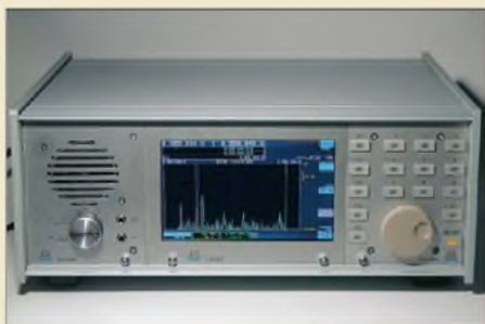
Ein neuer Trend in der Entwicklung softwaredefinierter Radios besteht darin, die Signalverarbeitung nicht einem externen PC zu überlassen, sondern die erforderlichen Komponenten gleich zu integrieren. Einer der ersten Vertreter dieser neuen Spezies ist der RDR54. Er kommt aus deutschen Landen und überstreicht einen sehr weiten Frequenzbereich vom Längstwellenbereich bis zum 6-m-Band.
