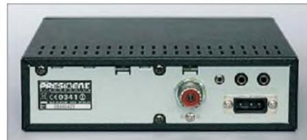
Auf der Rückseite lassen sich Antenne, Stromversorgung und externe Lautsprecher anschließen. Eine Buchse für ein externes S-Meter fehlt. Fotos: DL1ABJ
