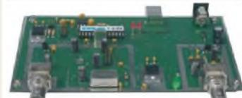
Bausatz FA-NWT 01-U mit aufgebaute/geprüfter Platine inklusive Reflexionsmesskopf und Abschirm-Kit
