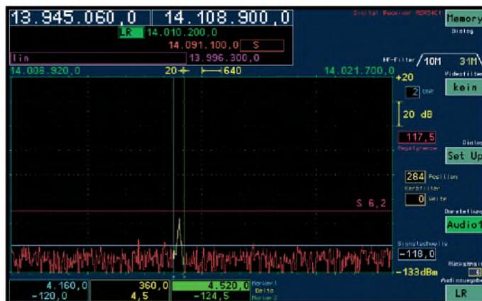
beträgt ausgedrückt in der anzeigeorientierten Arbeitsweise des Gerätes 3 dB zur nächsten benachbarten, außerhalb liegenden Spektrallinie und 120 dB zur drittnächsten. In praxi erscheint sie unendlich mit rechteckiger Flankensteilheit. Die Bandbreite ist zwischen 2,5 Hz und 20 kHz variabel. Alle innerhalb der Marker liegenden – im Spektrum gelb eingefärbten – Spektralanteile übersetzt der „Demodulator“<sup>1</sup> stur in Audiofrequenzen.
