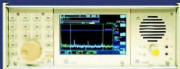
Digitalisierung direkt an der Antenne mit 17 Bit (SFDR > 105 dB)!
