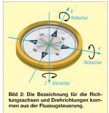
**Bild 2:** Die Bezeichnung für die Richtungsachsen und Drehrichtungen kommen aus der Flugzeugsteuerung.
