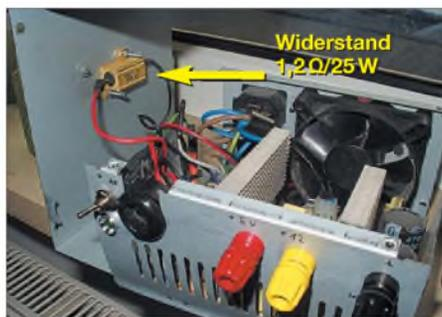
**Bild 2:** Der Anlaufwiderstand ist gut gekühlt zu montieren.
