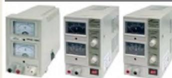
Preisgünstige Netzteile mit 2 gut ablesbaren Analoginstrumenten für Ausgangsspannung und -strom. Spannung einstellbar zwischen 0 und 15 V bzw. 0 und 30 V. Maximaler Ausgangsstrom 1, 2 oder 3 A. Klemmbuchsen für Bananenstecker.
