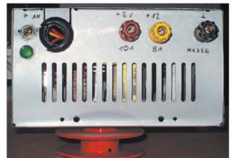
**Bild 4:** Das fertige PC-Netzteil nach dem Umbau
