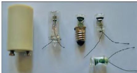
Bild 2: Verwendete Glimmzünder für Leuchtstofflampen und einige Glimmlampen
