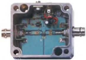
Bausatz mit Gehäuse für einen Breitbandverstärker für 10 MHz bis 2 GHz. MMIC-bestückt, etwa 19 dB Verstärkung, Ausgangsleistung 1 GHz bei 1-dB-Kompression typ. +20 dBm (100 mW). BNC-Buchsen. UB 12-18 V DC, 110 mA.
