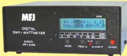
Der eingebaute Frequenzzähler misst sehr genau (+/- 1%), auch die Leistung wird sehr präzise angezeigt.
