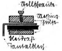
Abb. 2 zeigt, wie man den Tantalstreifen, der sich nicht löten läßt, mit dem Blei durch Verschraubung verbindet.
