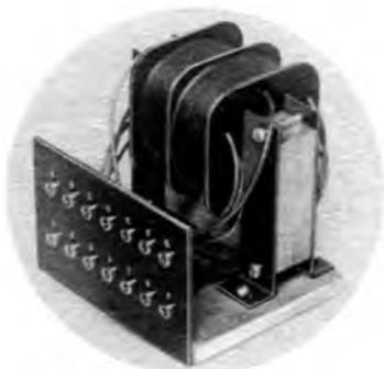
Abb. 1. Das ist der normale Vorgelege-Trafo mit je 7 Anschlüssen jeder Wicklung.
