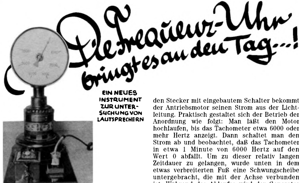
Der Zeiger gibt in jedem Augenblick die genaue Schwingungszahl an, die der Lautsprecher aufnimmt.
