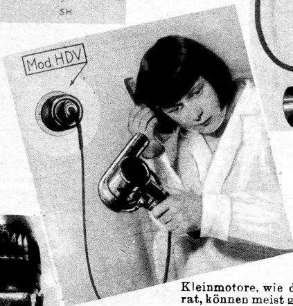
Eines der Vorschalt- filter für unruhigen Netzgleichstrom, auch Glätteinrichtung genannt. Zahlreiche Firmen bringen derarti- ge Glätteinrichtungen.
