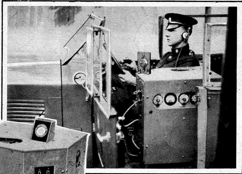
Der Chauffeur ist gleichzeitig Funkker. Die Taste befindet sich auf dem Steuerrad.
