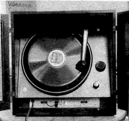
An dem Schaub-Gerät, Type Bali, ist sehr interessant die Unterbringung des Schallplattenlaufwerks. Es ist zugänglich nach Öffnen der Rückwand; Plattenteller und Tonarm stehen nahezu senkrecht. Phot. Gulliland.
