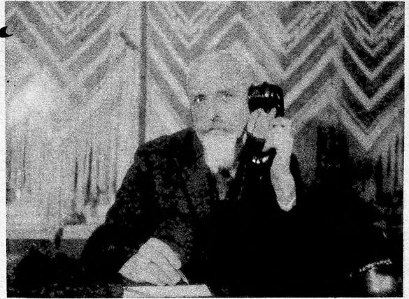
Ohne Abänderung kann jeder normale Kopfhörer zur Aufnahme von Telephongesprächen auf Schallplatten verwendet werden. Es wird einfach ein Zusatzstück auf den Hörer aufgeschoben, das das Mithören selbstredend nach wie vor gestattet.
