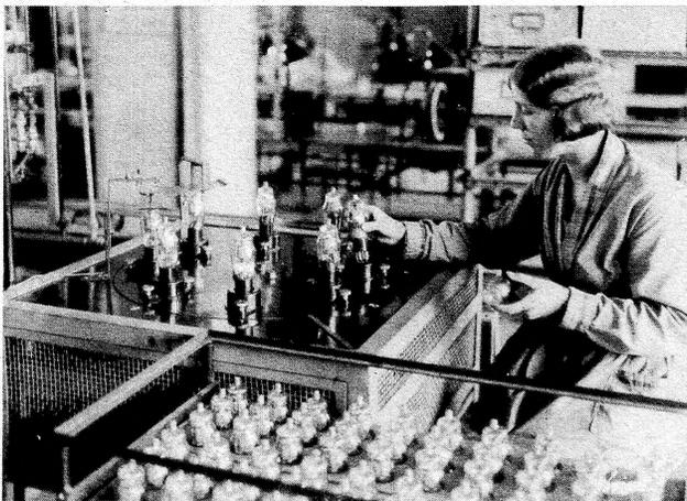
Die Hexoden sind fertig, aber sie müssen noch ein letztes Mal unter Strom gesetzt werden, wobei man es auf die Gasreste innerhalb der Röhre abgesehen hat.
