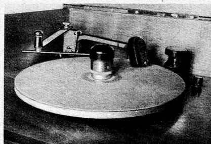
Abb. 5. Spieltisch mit Saja-Motor, Dralwid-Schneidvorrichtung und Wumo-Plattentellerbeleuchtung.
