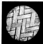
Achtzigfach vergrößerte Aufnahme des Draht-Baumwollgeflechts zur Zugentlastung an der Telefunken-Silberantenne.
