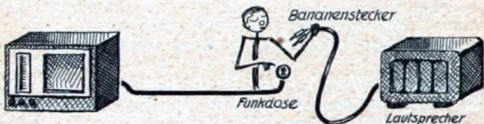
Ans Ende der Lautsprecherleitung setzt man eine fogen. Funkdose. Da hinein kommen die zwei Bananenstecker des Lautsprechers.
