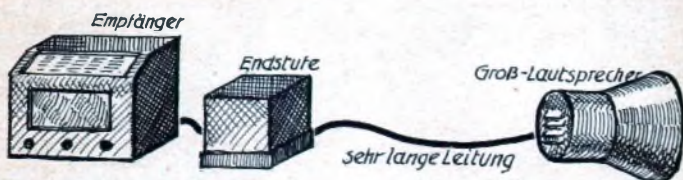
Für richtiggehende Unterhaltungsmusik in Gartenwirtschaften usw. brauchen wir noch eine Endstufe hinter dem Empfänger.
