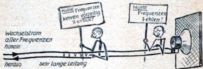
Eine lange Lautsprecherleitung färbt die Wiedergabe dunkel.
